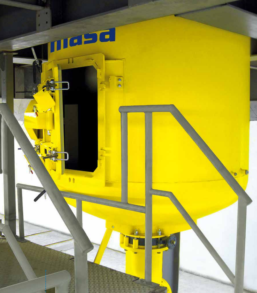
图4：高性能搅拌机的侧向维护通道
