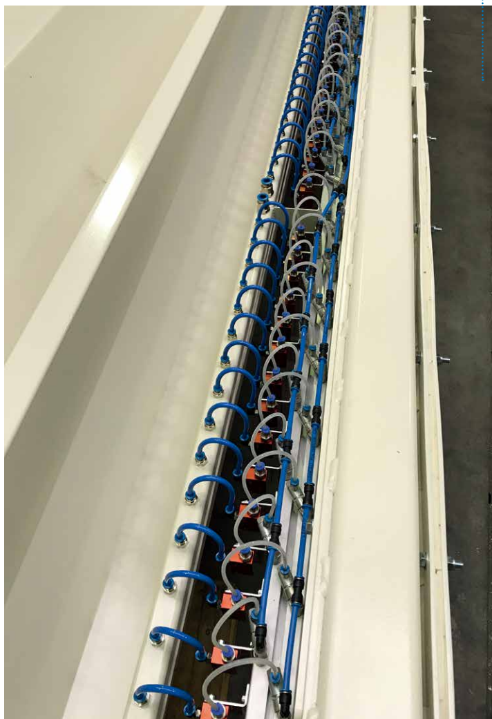
图8：艾尔柯瑞特模具清洁和涂油系统的独立可调喷嘴
