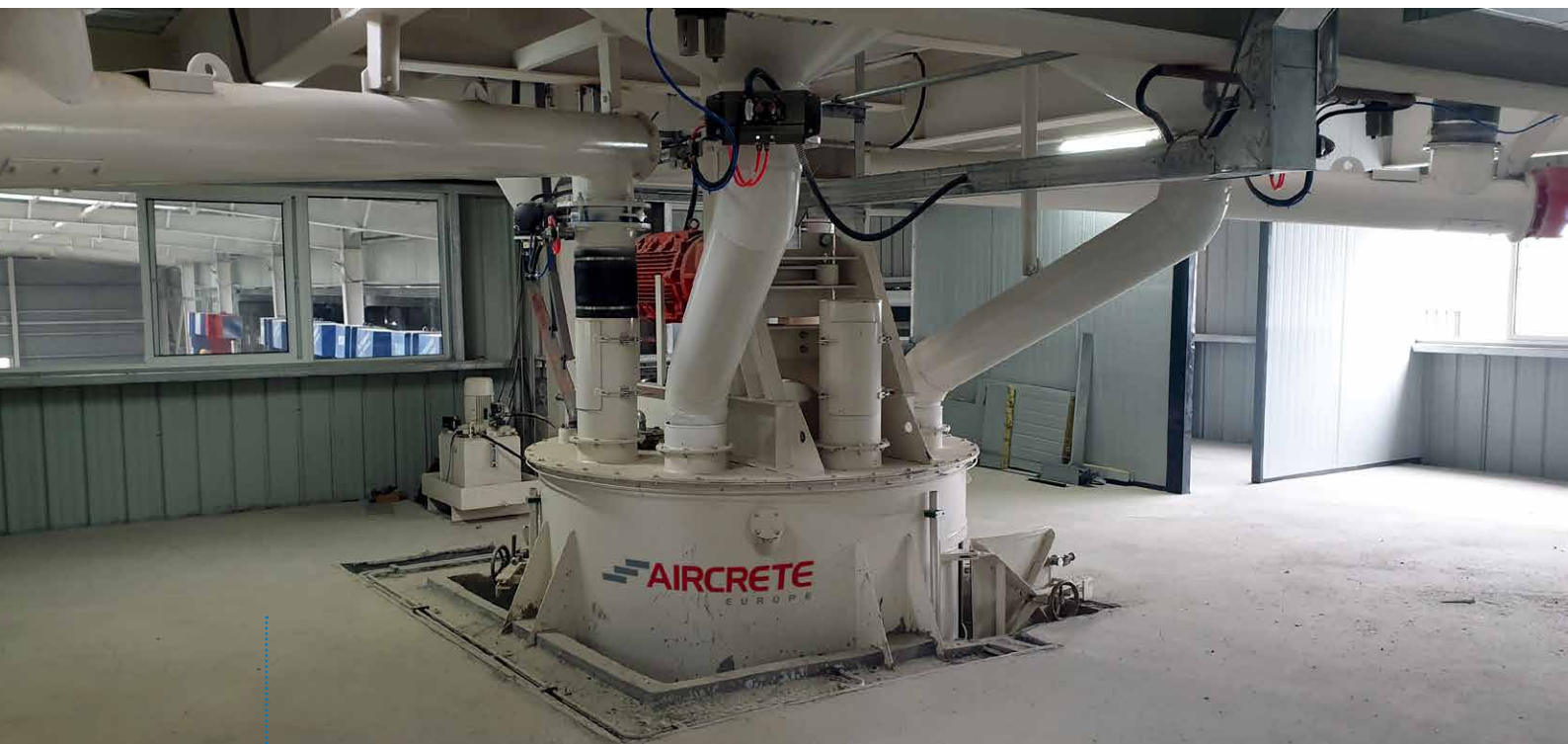
图5：艾尔柯瑞特多桨低速搅拌机能充分搅拌混合料，达到高度均匀的状态
