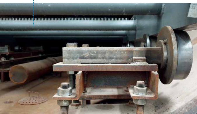
图14：带特殊轴承的高压釜滚轮特写
