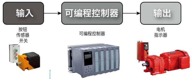
图1: 传统的PLC控制架构
