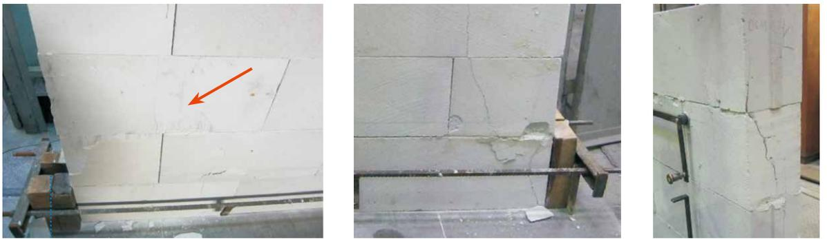
图3: SIN系列模型裂缝细节——无强化
