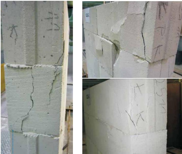
图4: S1Zk系列模型裂缝细节——桁架强化
