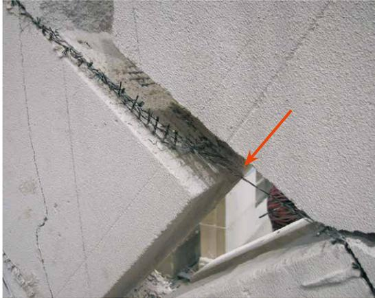
图8: 双侧涂砂浆强化墙体损毁的典型形式:
