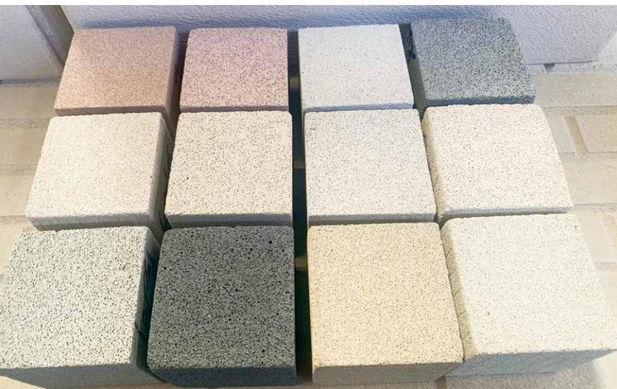
不同固废原材料制作出来的AAC样块
