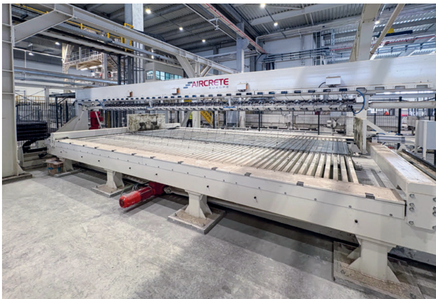
图6：AE独立横切机，配备短切割钢丝及集成压板（lamella）压实装置，用于提升切割精度
