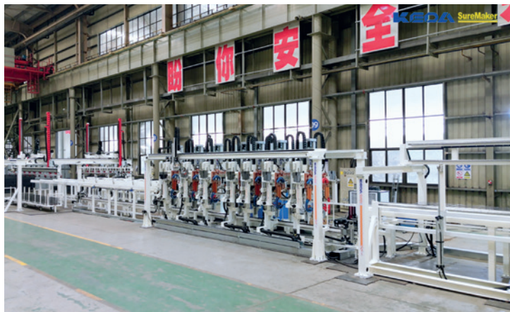
KEDA SUREMAKER开发的K-ARFAS自动钢筋网笼装配系统
