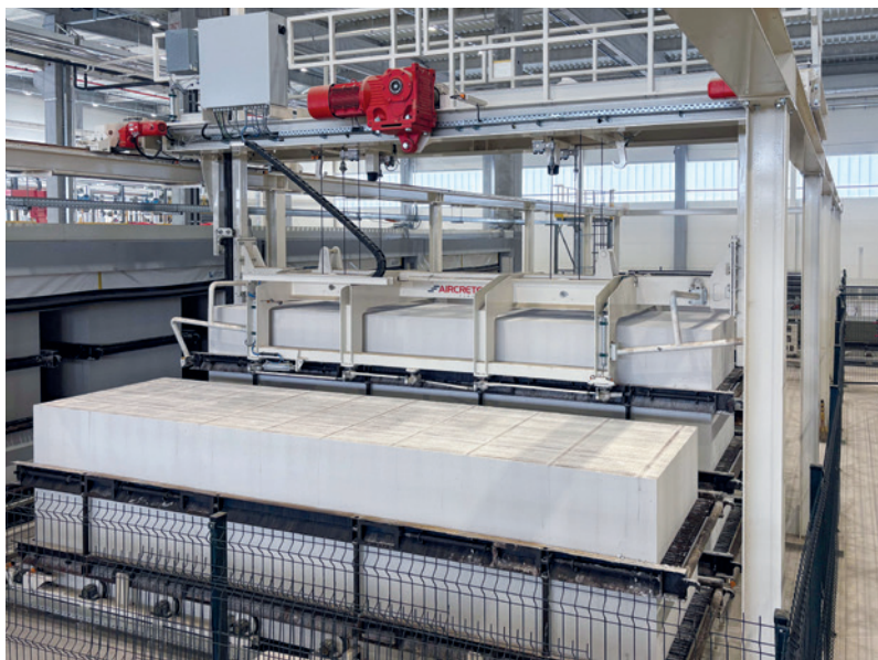
图8：堆垛/拆垛机械手，可实现灵活的产品打包配置，以提高下游包装与发运效率
