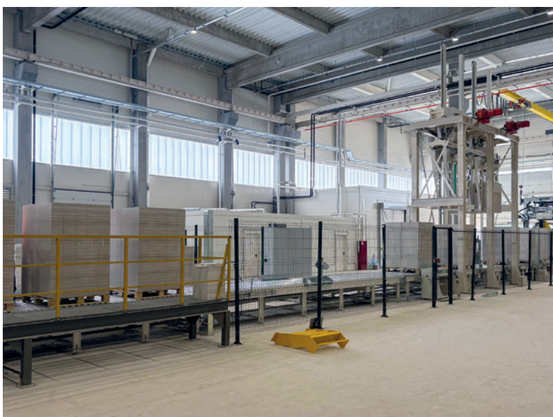
图9：卸载生产线，具备自动化包装配置功能，可灵活调整托盘高度并进行产品分拣
