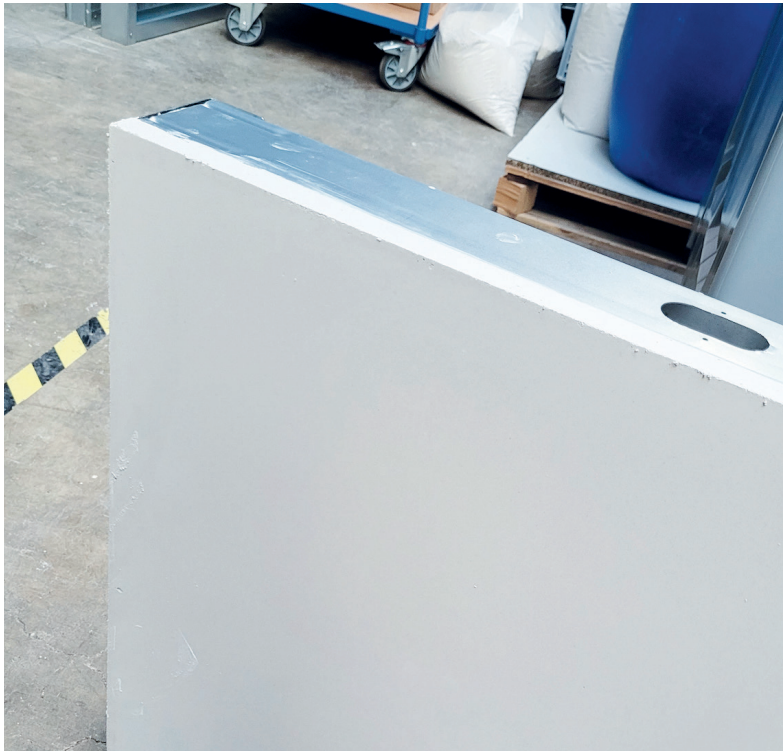
图 6: 采用石膏基自流平砂浆的钢框架墙体构件 (60x80 厘米)
