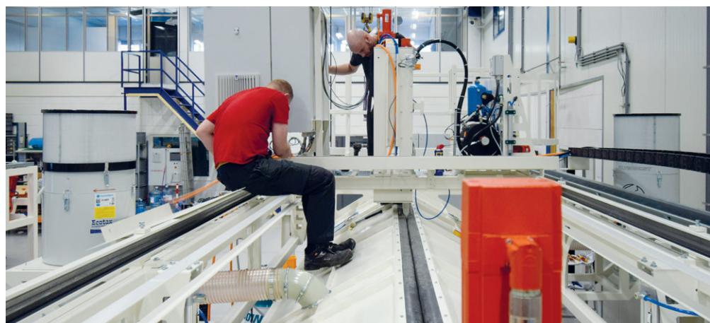
图 6: Aircrete Europe 工程师在车间安装和测试期间组装模具涂油系统
