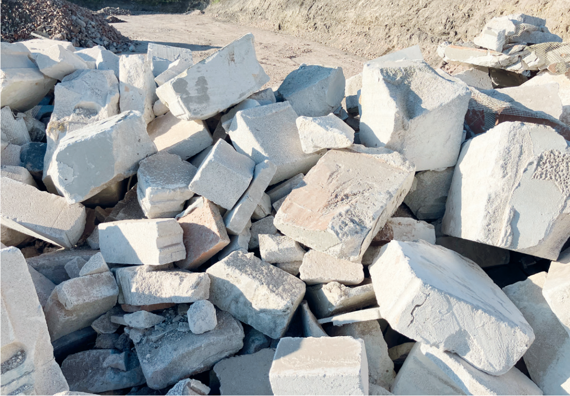
图 1: 密度等级为 340–570 kg/m 3 的混合加气混凝土建筑与拆除废料
