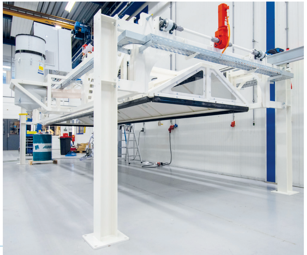
图 1：在安装到加气混凝土生产线之前，在 Aircrete Europe 车间组装的闭模涂油机
