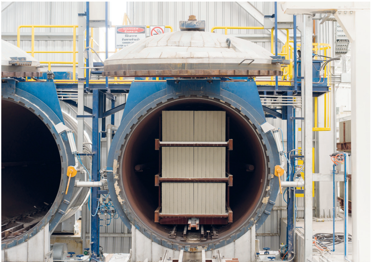
卧式蒸养是这家泰国新工厂生产AAC制品的核心工艺之一
