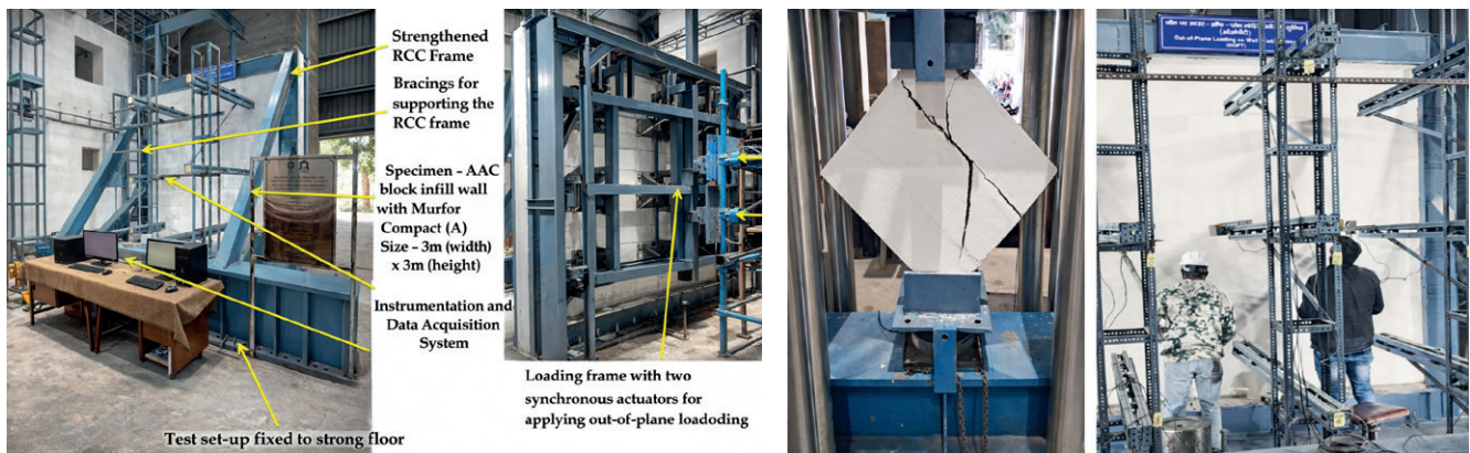
使用 Murfor Compact 灰缝配筋的实验室测试
