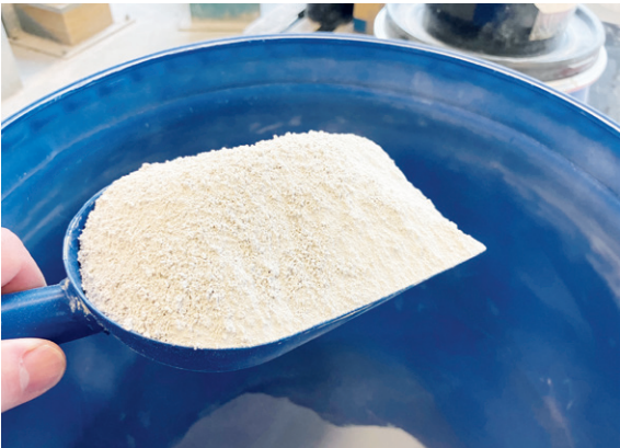
图 2: 加气混凝土颗粒 (< 4 毫米)
