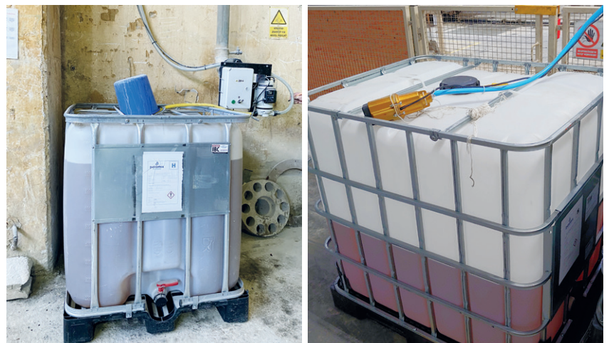
图 1：带外置泵的中型散装容器 (IBC) (左)；带浸入式泵的中型散装容器 (IBC) (右)。来源：PMX Labs
