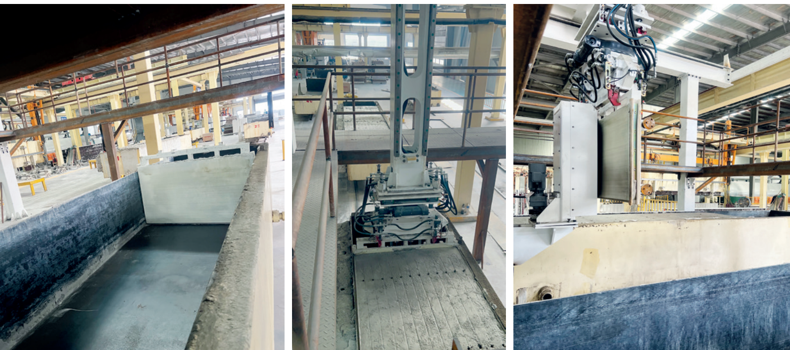
严格控制原材料浪费：通过精确的隔板定位和同步控制，有效避免浆料溢出和成型偏差等问题
