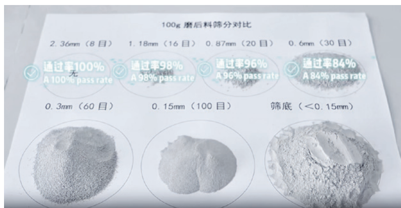
图4：废料回收装置——设计布局、模拟生产线和磨后物料的筛选结果
