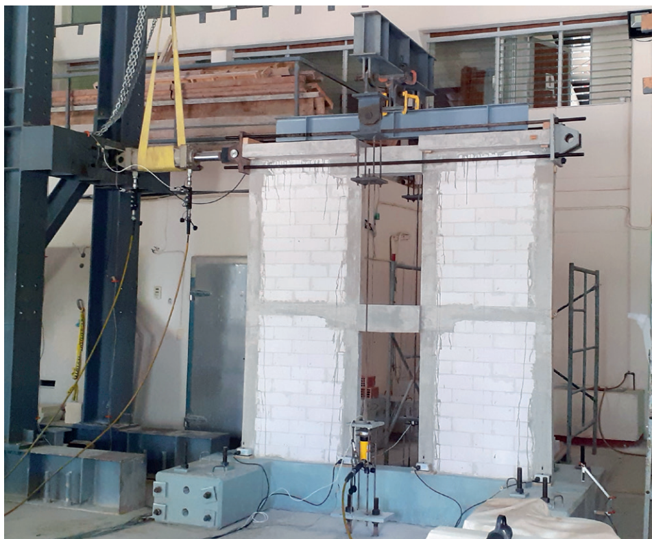
图3：双层AAC耦合墙体 试验装置
