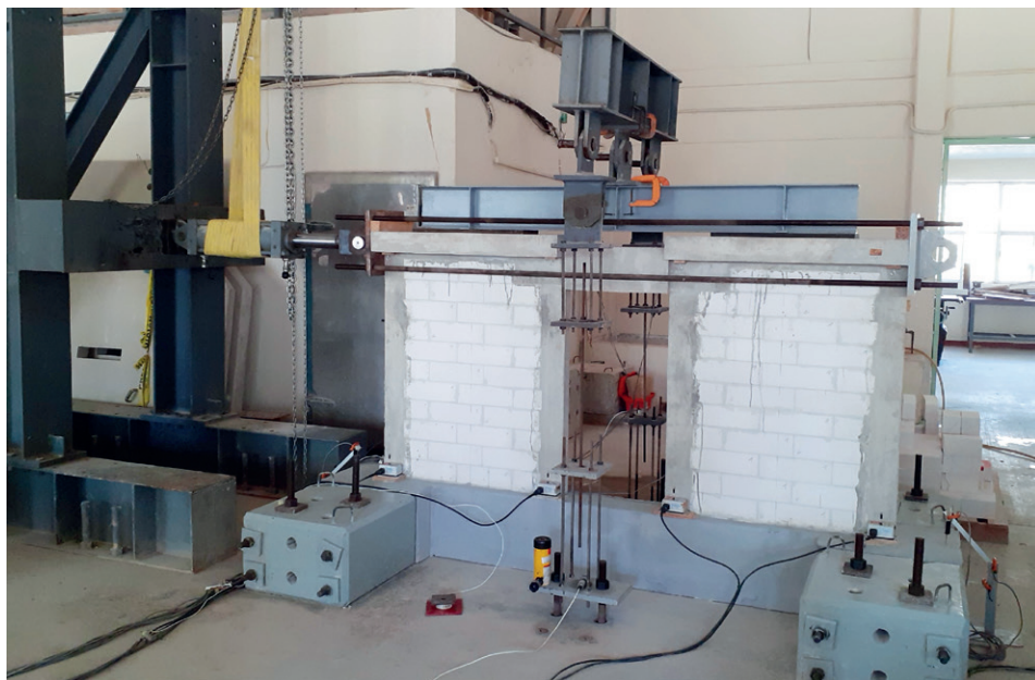
图2：单层AAC耦合墙体 试验装置
