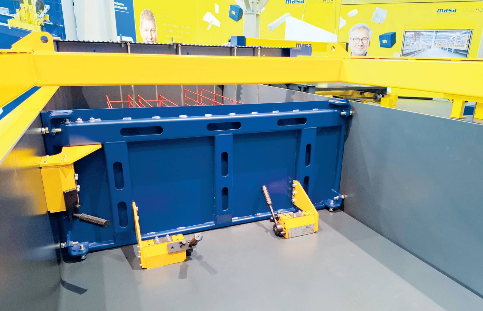
模具优化应用：三个可切换永磁体将隔板稳固连接至模具底部及单侧板，形成定制化浇筑空间
