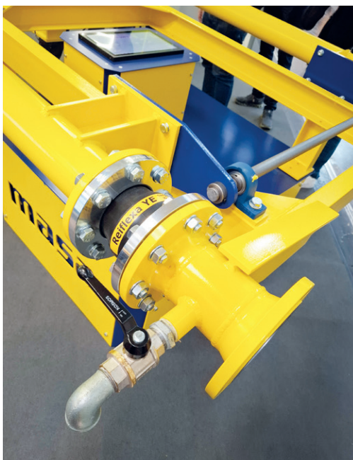
补偿器、取样出口及称重装置
