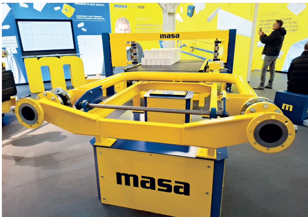
用于自动计算浆料密度的管道回路秤
