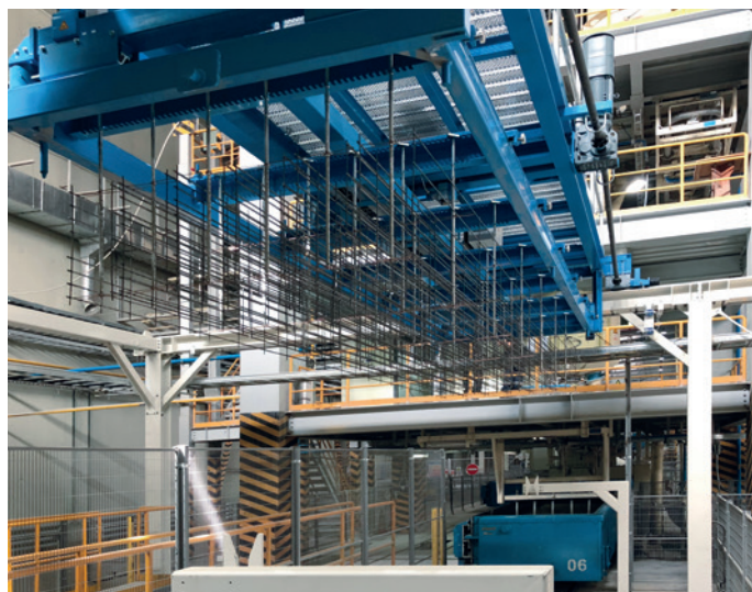
步骤 3：将整个钢筋插入新鲜蛋糕中
