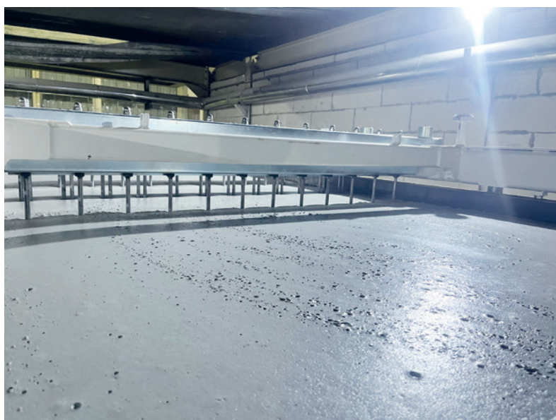
图6：在预养区域插入钢筋保持框架的模具
