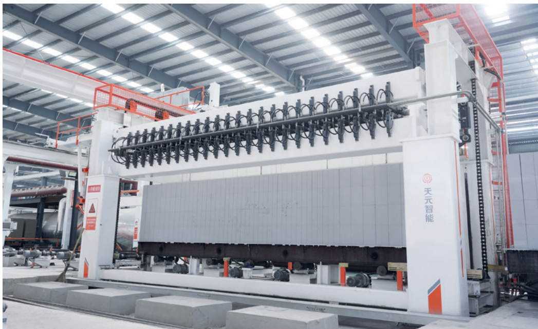
用于坯体快速掰分的高精度掰板机
