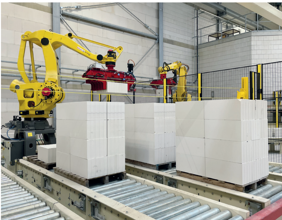
使用机器人卸载AAC砌块
