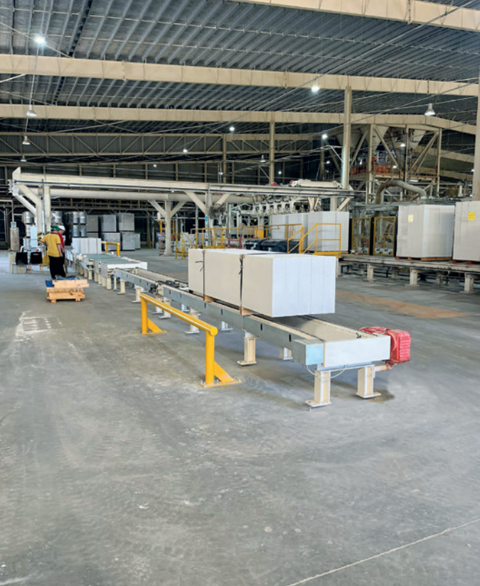
图2: Brimax生产的第一批150毫米厚的面板。捆扎并准备发货
