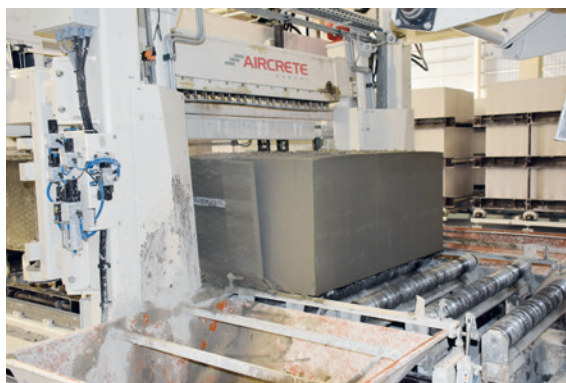
图8：横切坯体经过高速切割架（HSCF）
