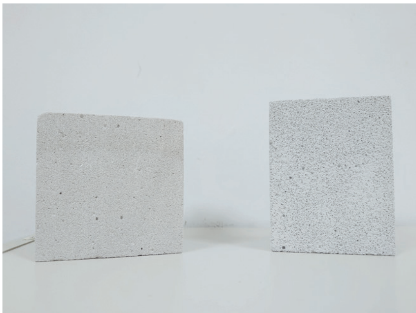
图4: BAAC试样(左)与 AAC试样(右)的比较
