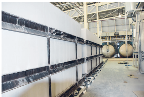
图9：出蒸压釜后，硬化的坯体被堆叠成3层高
