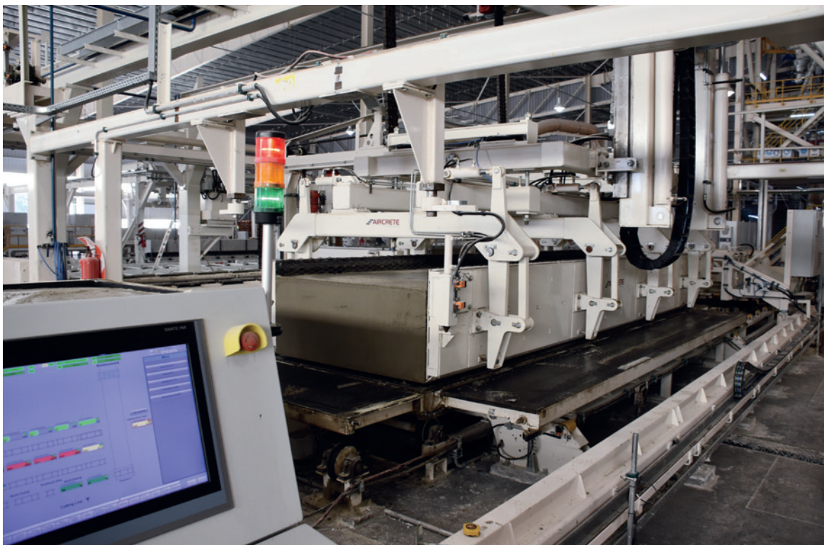
图7：移坯天车将坯体从打开的模具中取出并移至切割线上
