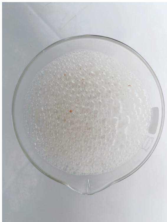
图1：酵母细胞和 \text{H}_2\text{O}_2 系统中发泡过程的发展
