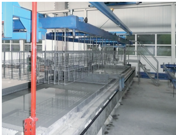
步骤 1：通过浸入涂层浴中来保护钢筋免受腐蚀
