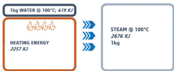
图2：1公斤水转化为蒸汽的相变
