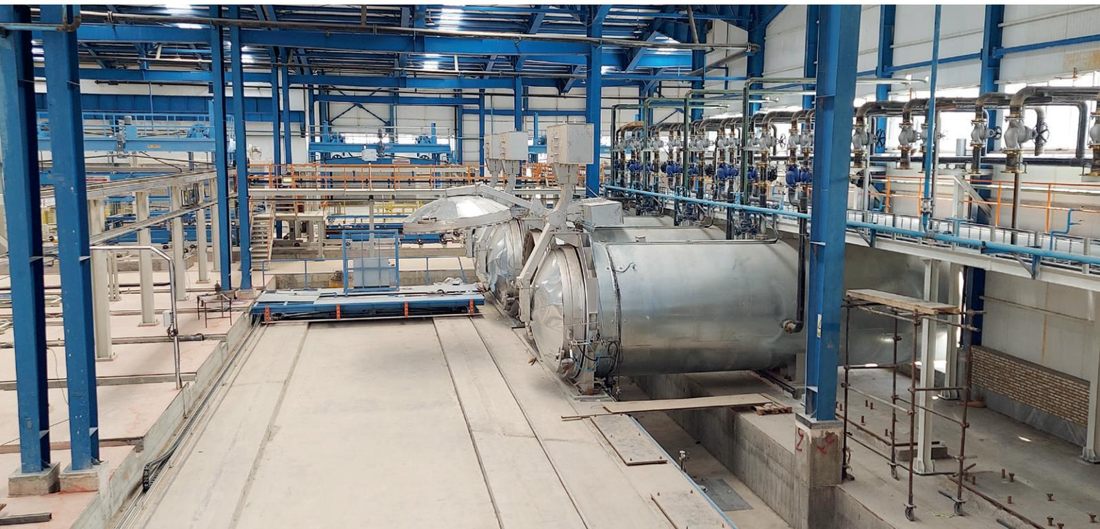
图 1: AAC 工厂中的高压釜截面
