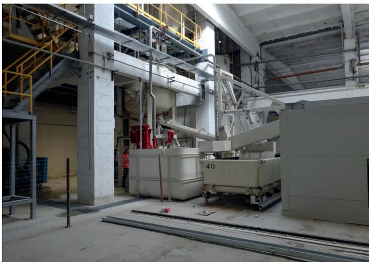
图 1：现代化 Aircrete 设计的搅拌机将混合物排放到模具中
