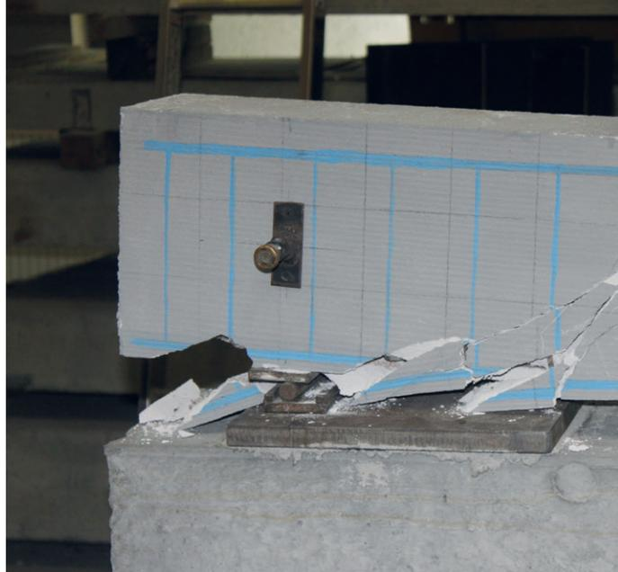
缝。在测试的最后阶段，在底部钢筋高度处出现了水平裂缝（见图 5A）。根据梁裂缝的形态，确定了决定性破坏裂缝相对于梁纵轴的倾斜角度。测试结束后，对靠近支撑区域的梁钢筋进行了目视检查。所有过梁中均观察到水平箍筋臂发生了屈曲（见图 5B）。
