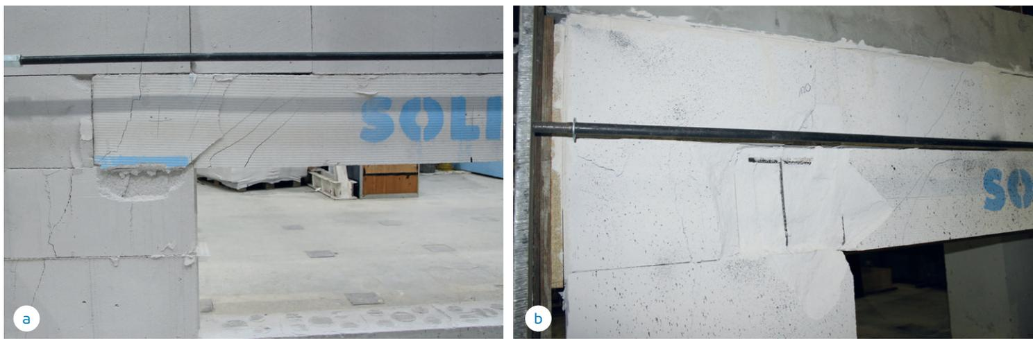
图7: NIII系列模型损坏视图: a) 支撑区域的损坏 b) 靠近支撑区域的AAC过梁压碎情况
