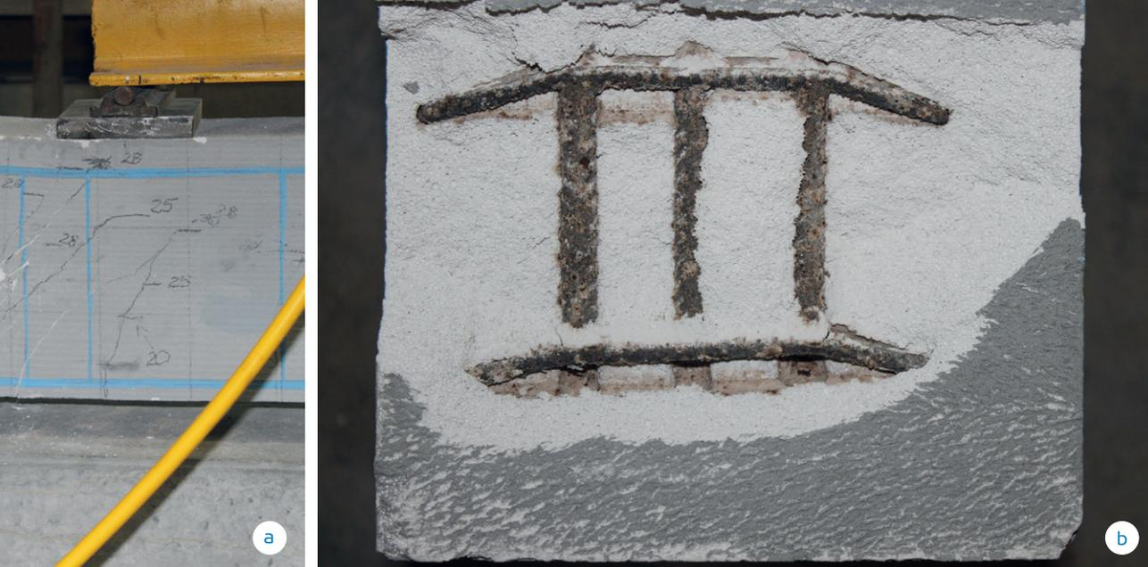
图6: C系列构件在破坏时的视图: a) 靠近支撑区域的裂缝区域 b) 靠近支撑区域箍筋臂的变形
