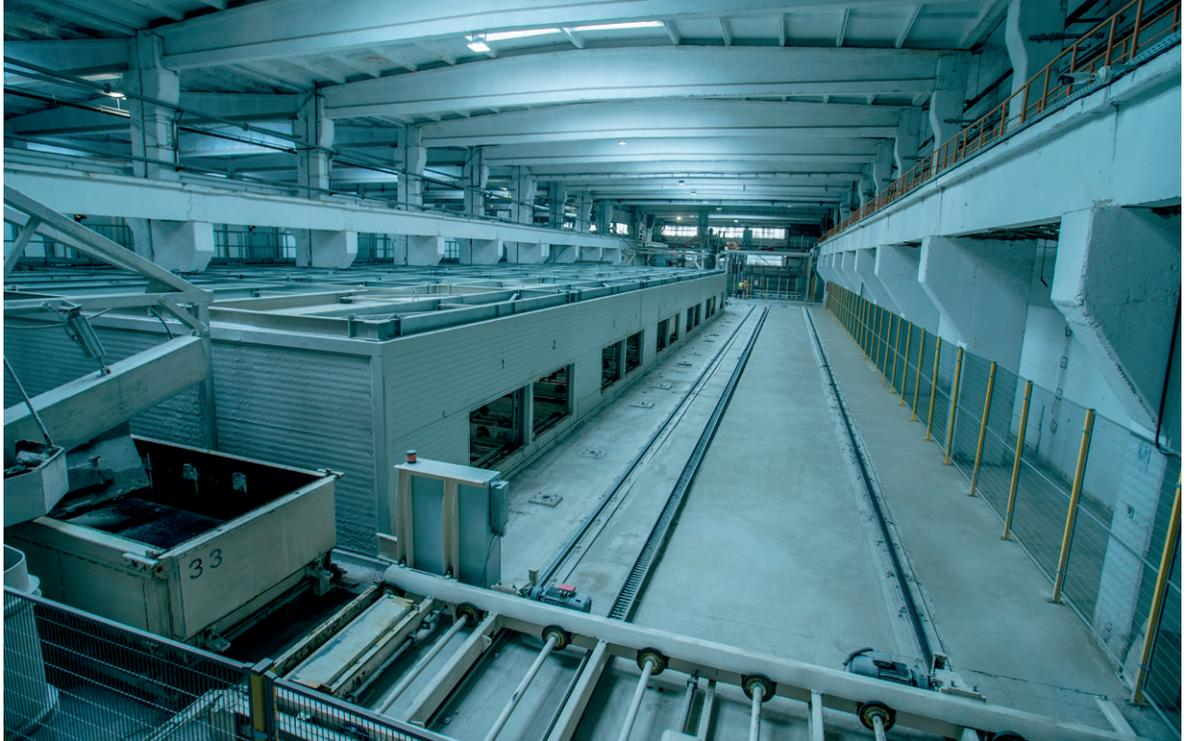
图 5: 罗马尼亚 Holcim 工厂的 Aircrete 模具膨胀区域和模具横移车
