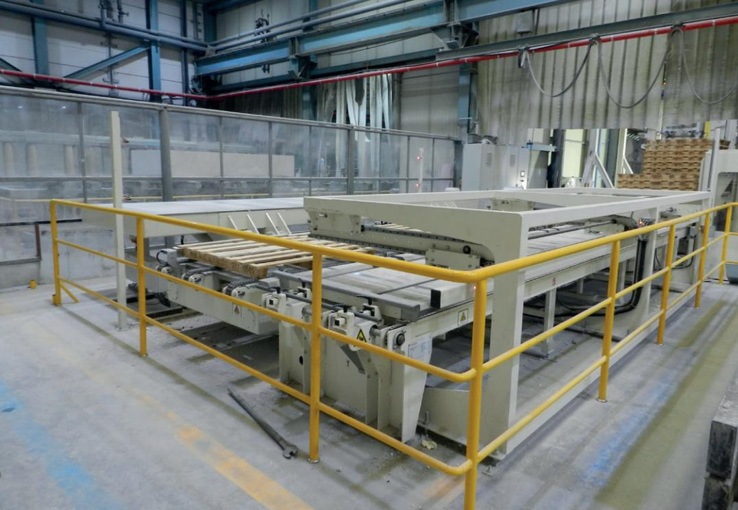
图 11: 韩国 SYC 工厂的双坯倾斜台
