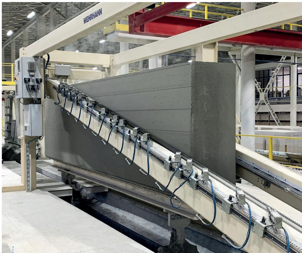
图3：切割丝的均匀分布减少了横切过程中的应力
