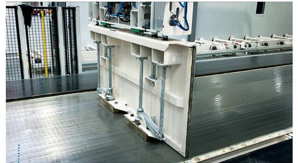
图6：Aircrete可移动模具门的操作：自动门操作器从门架中取出可移动门，并将其放置在所需位置
