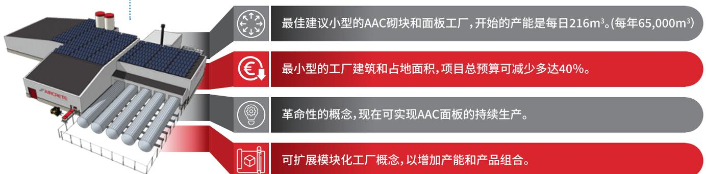
些面板被定义为厚度100毫米或更薄的面板，能够以更大的产量和更可持续的方式生产（意味着标准AAC工厂内可接受废料水平不应超过块状产品的1%，或面板产品的2-3%）。
