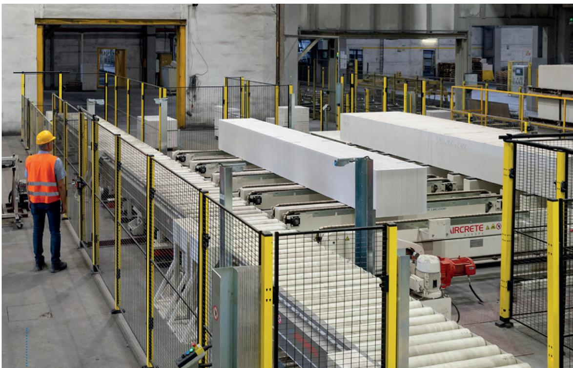
图9: Aircrete面板包装配置系统是全自动配置不同的包装尺寸
