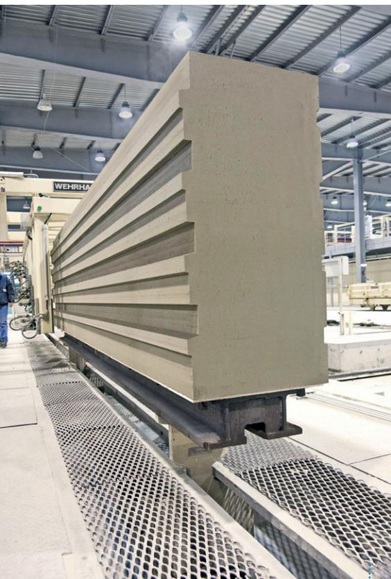
图2：翻转切割系统易于对坯体侧面进行高精度加工
