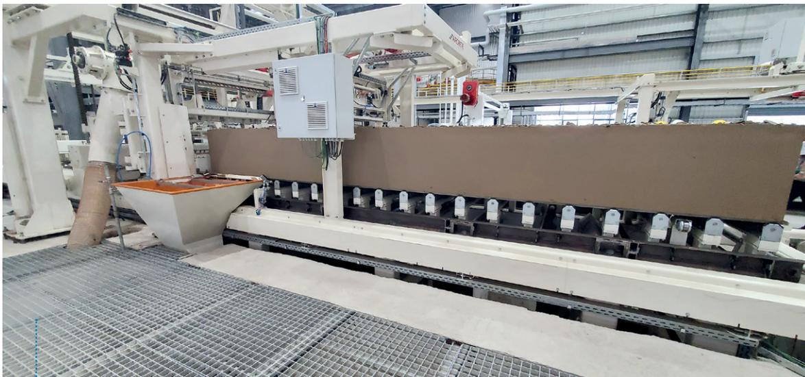
图7：在Aircrete所有工厂中，面板从铸造、上升、切割到卸载过程中始终保持水平，无需分离或翻转绿色面板机
