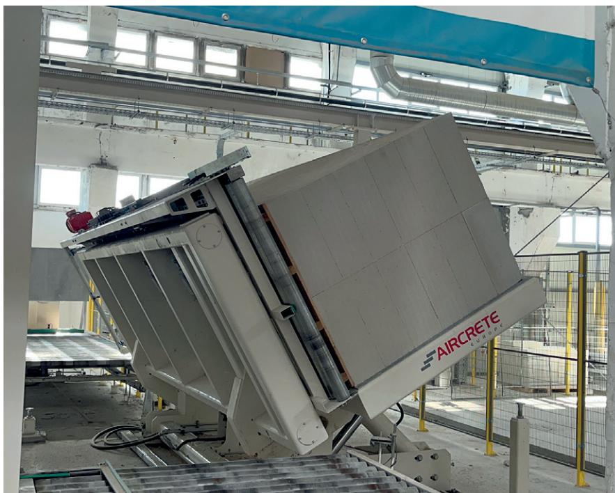
图8：翻转台全自动地将两个完整的坯体同时翻转至六个托盘上
