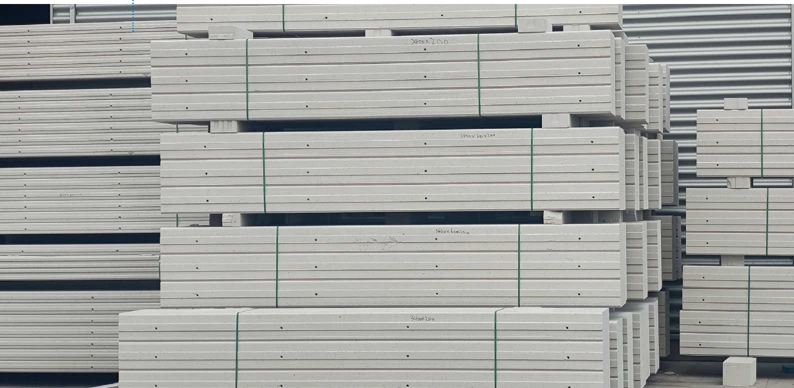
图1：正常生产的AAC板材
