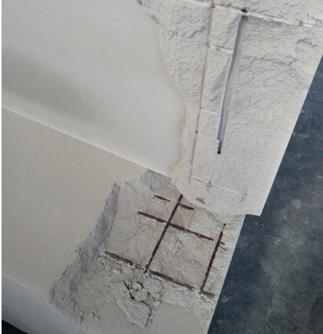
图4: 在错误的高压灭菌过程后出现的典型裂纹图案
