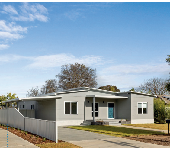
图12: 另一个在澳大利亚地区使用可运输的AAC模块化承重系统建成的住宅。(图片由建筑供应公司提供)
