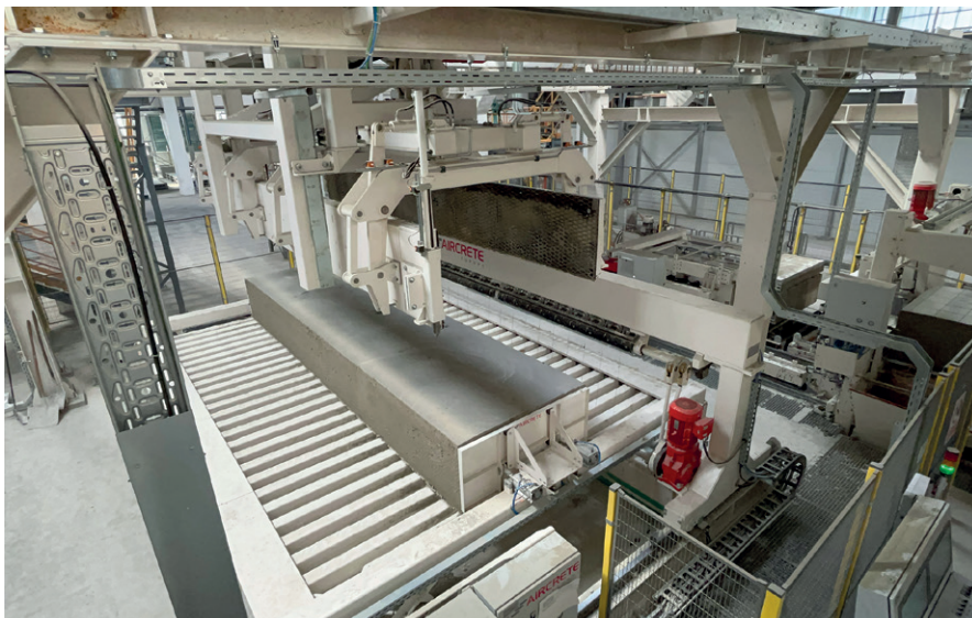
图6：图5切割机的视图（可见板条）。在视图后方，水平切割后的坯体已经被放置在切割线的下一工段上
