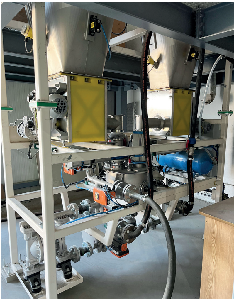
图4：新一代Aircrete铝膏计量系统
