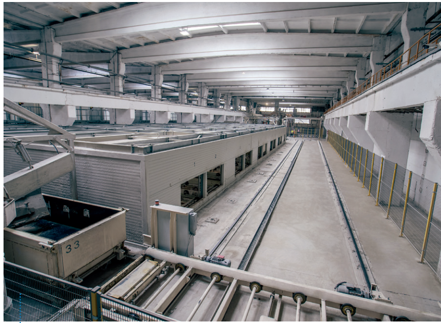
图2：搅拌塔俯视图。完成浇注的模具车经由Aircrete摆渡车全自动地移动到新型恒温预养区域
