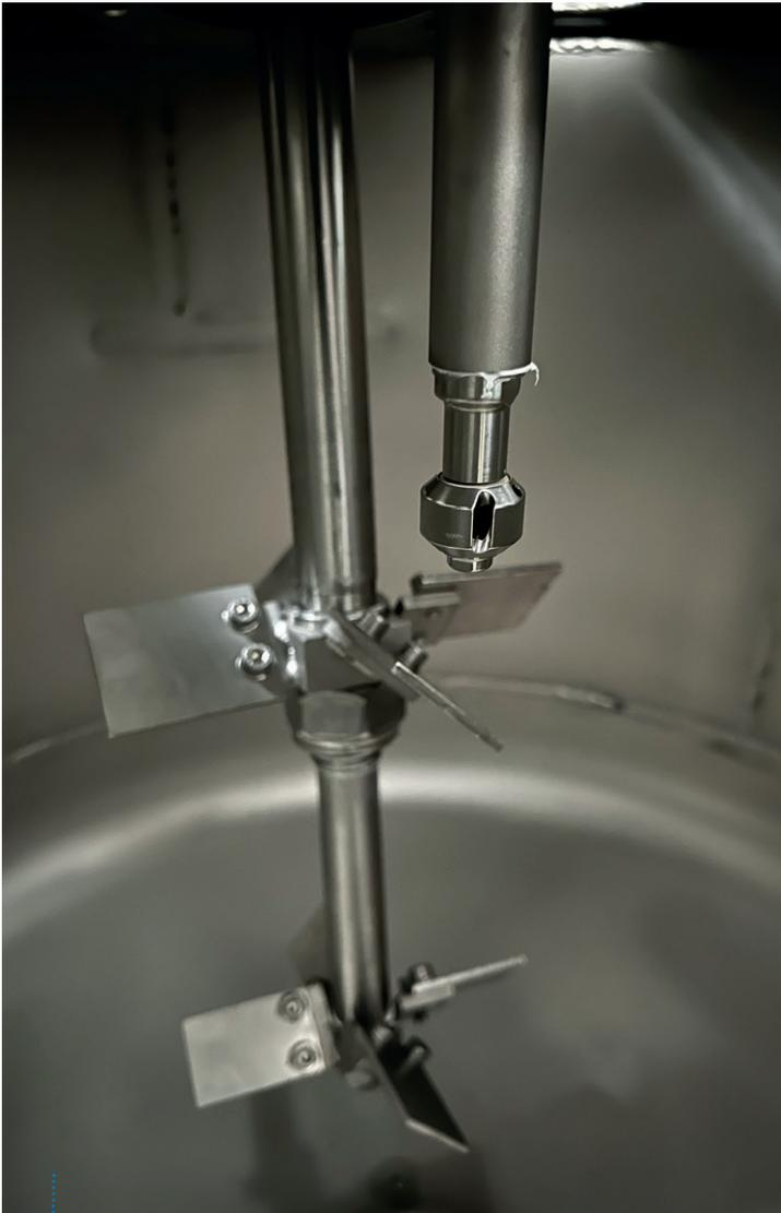
图3: 配料搅拌装置的内部构造 (搅拌器和压力喷嘴)
