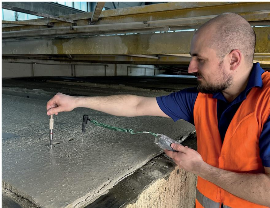
常可以看到每个砌块粘度测试的效果。在铝剂量不变的情况下，较低的粘度往往可以产出更高的砌块。这里也可以直接看到水对温度的影响。如果尝试应用含水量较低的混合物配比，则温度读数会更高。
