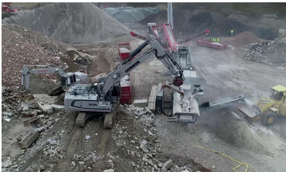
Osterried Entsorgung GmbH公司对加气混凝土废料进行处理(破碎/分拣/筛选)
