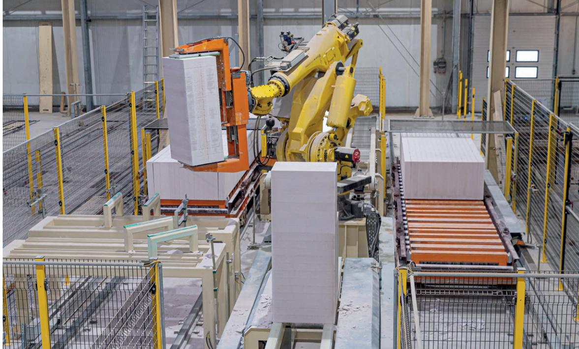
机器人将加气混凝土砌块组成一个包装
