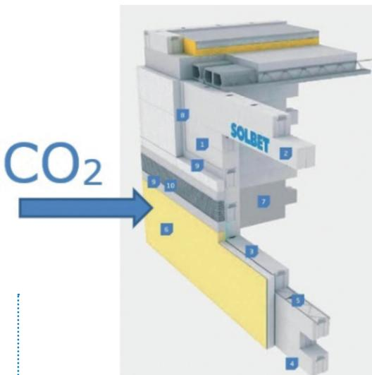
图7: 二氧化碳渗入蒸压加气混凝土墙体
