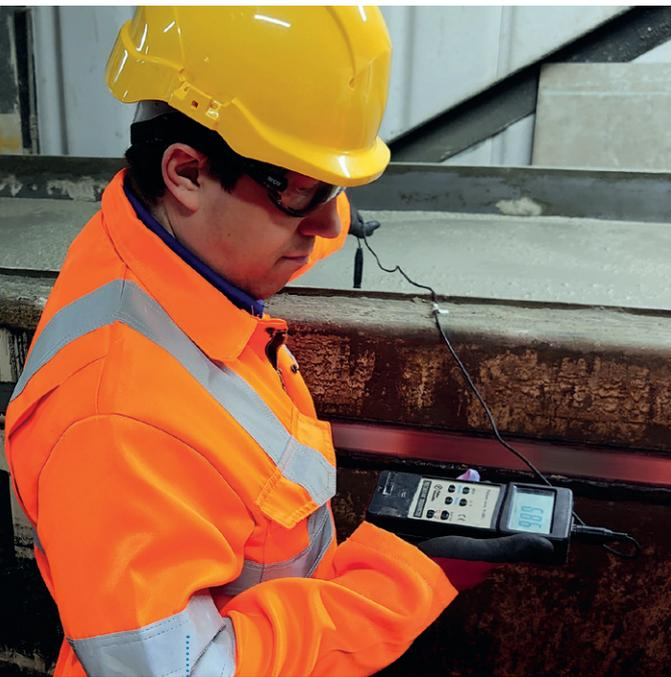
图4、5: 测量温度和硬度
