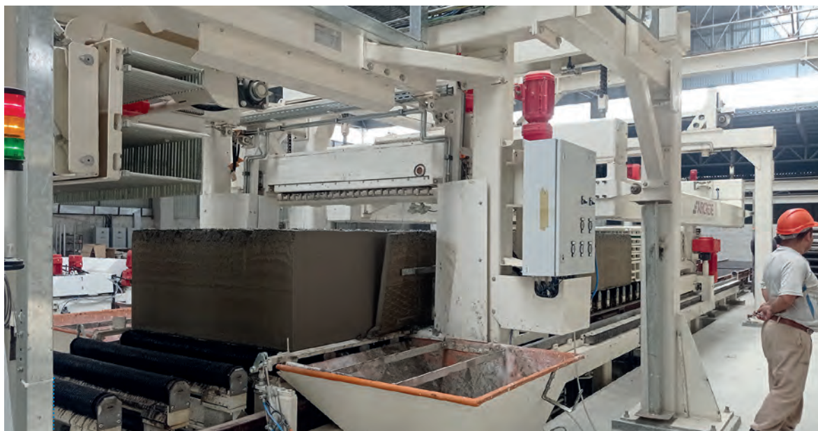
图 2: AAC 工厂的核心工段, 配备独特的艾尔柯瑞特水平切割线
