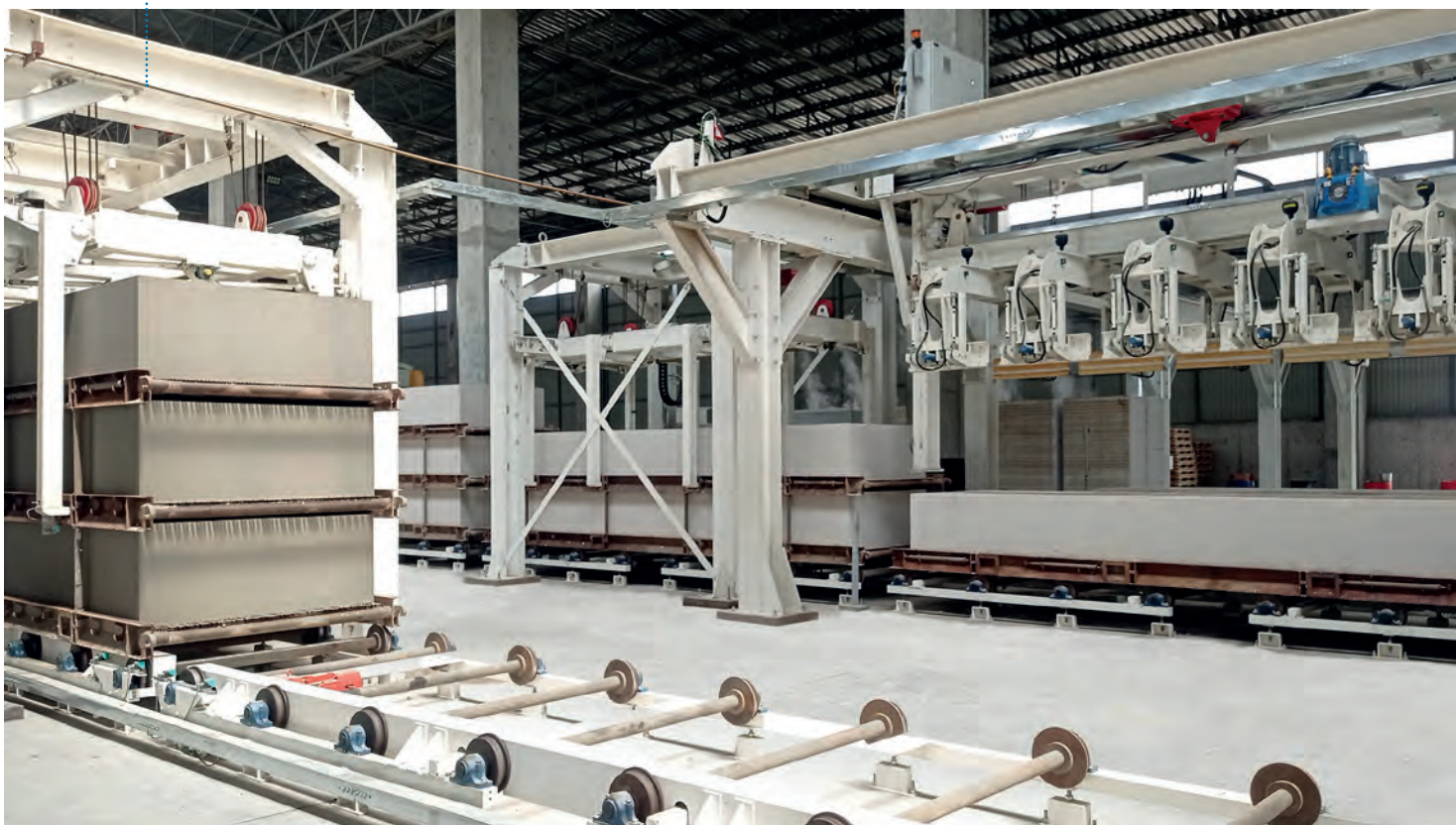
图 4：湿坯堆叠和成品坯体堆叠。Aircrete 在中国的制造工厂生产的设备示例
