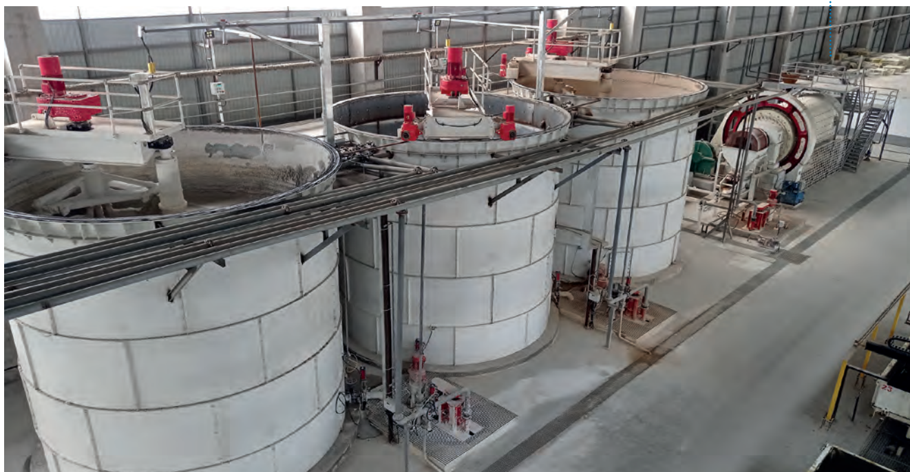
图 3: 原料准备区, 有 3 个 (150 立方米) 料浆罐和一台 25 吨/小时的球磨机
