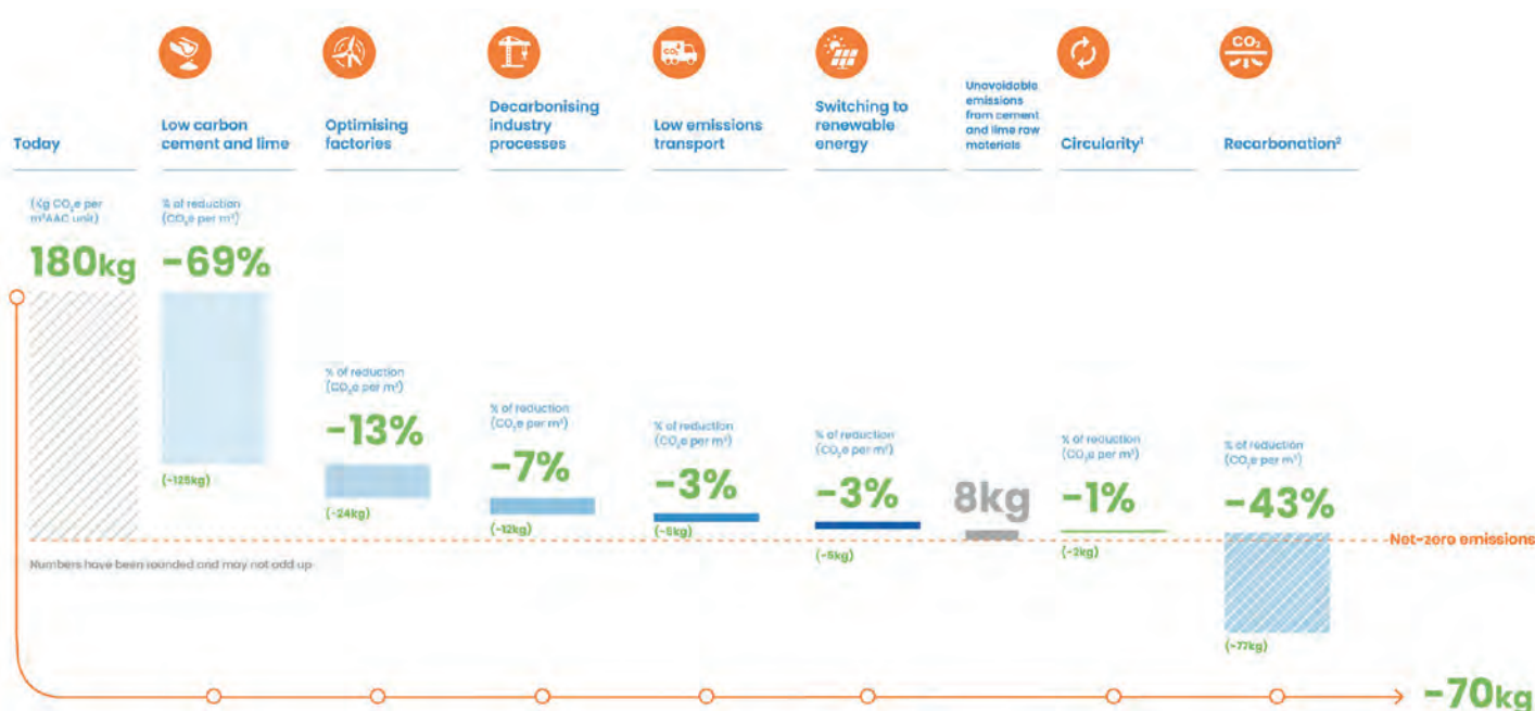
图5: AAC 路线图: 到2050年, ACC生产过程的二氧化碳排放量将从每立方米180公斤降至70公斤。(图片来源: EAACA Net-Zero-Roadmap-for-AAC-2023)
