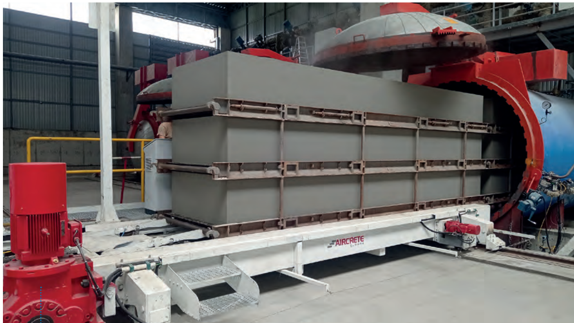
图5：使用蒸养小车装载和卸载蒸压釜
