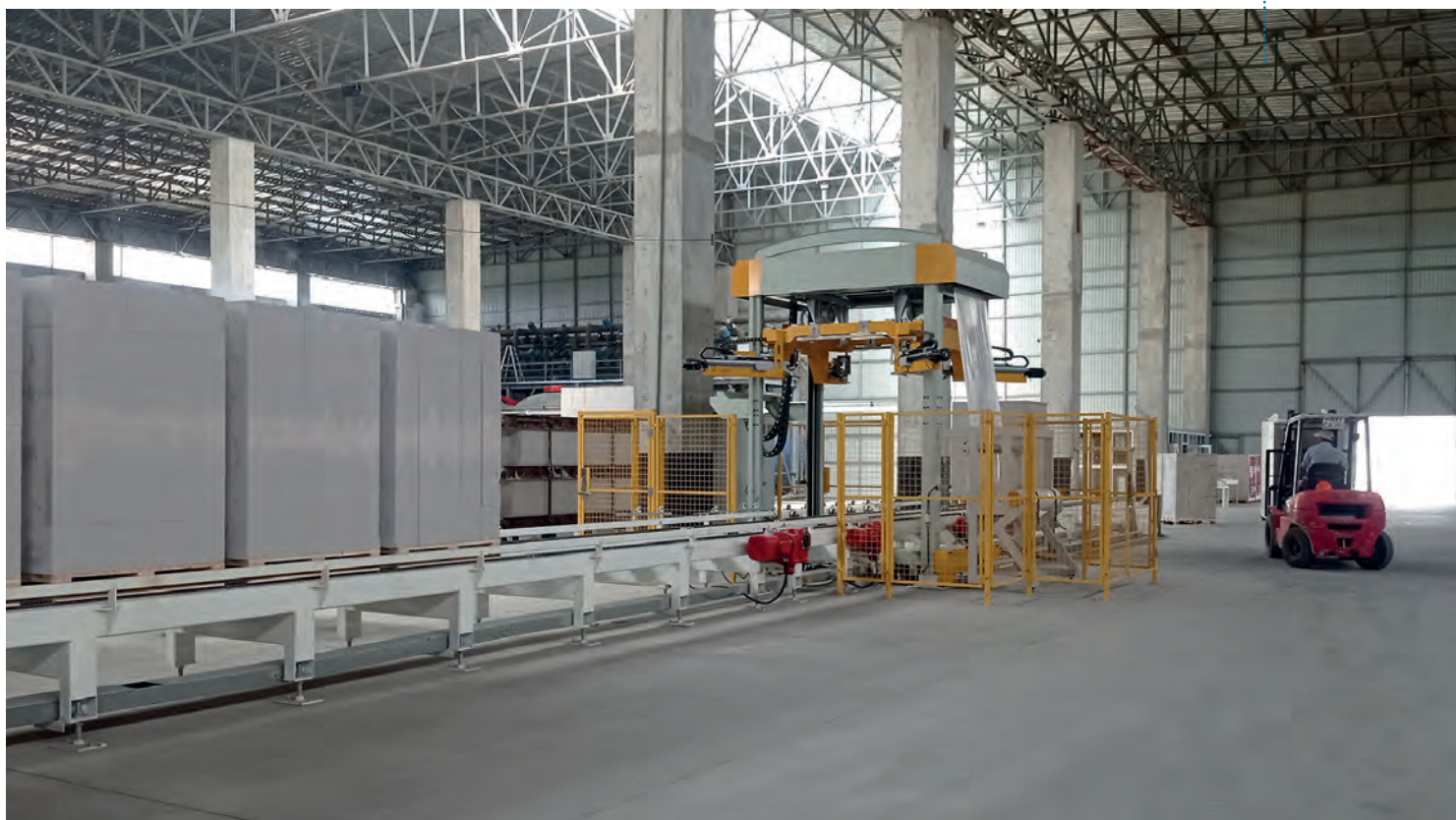
图 6：配备拉伸覆膜机的自动包装线
