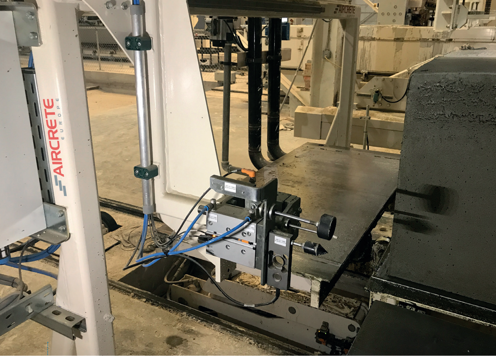
图3：硬度和温度测量设备已经成功地在其他客户的工厂中使用（例如美国）
