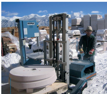
在完成铣削操作后，将各个锥盘组装起来，用垂直不锈钢棒加固，涂上底漆，然后对整个锥进行镀金
