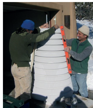
在完成铣削操作后，将各个锥盘组装起来，用垂直不锈钢棒加固，涂上底漆，然后对整个锥进行镀金
