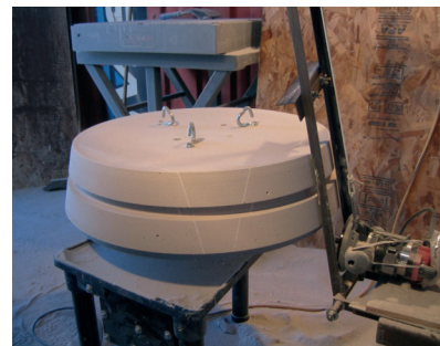
最后一个结构外形是一个 13 级高的锥形塔尖，象征“火”。由于涉及到切割各种尺寸的 AAC 巨型砌块，并将它们粘在一起，加工成锥形圆盘，方案极具挑战性。
