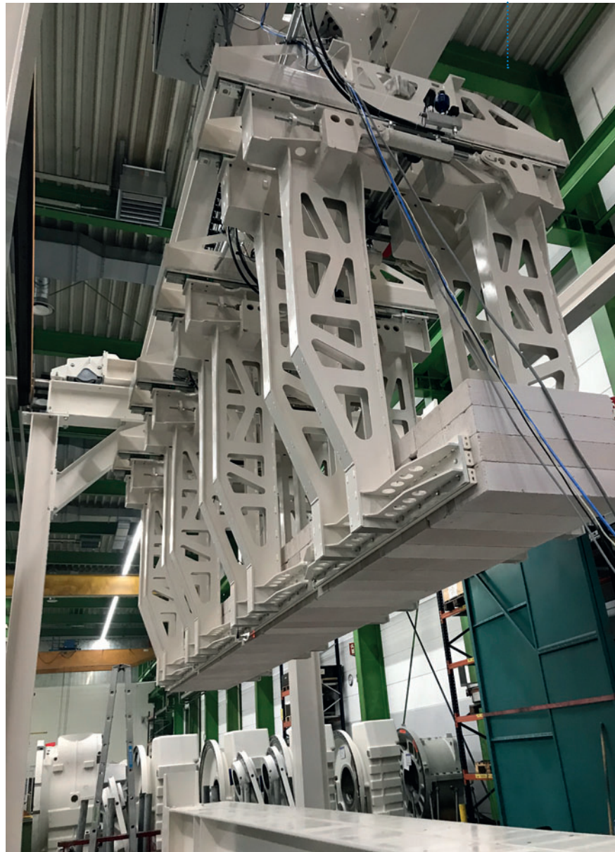
图2：2021年在荷兰正在进行检验的成品卸料天车
