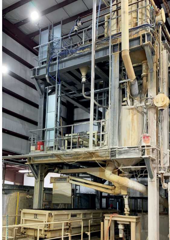
搅拌单元包含大量设备，由威翰智能配料和搅拌系统独立控制
