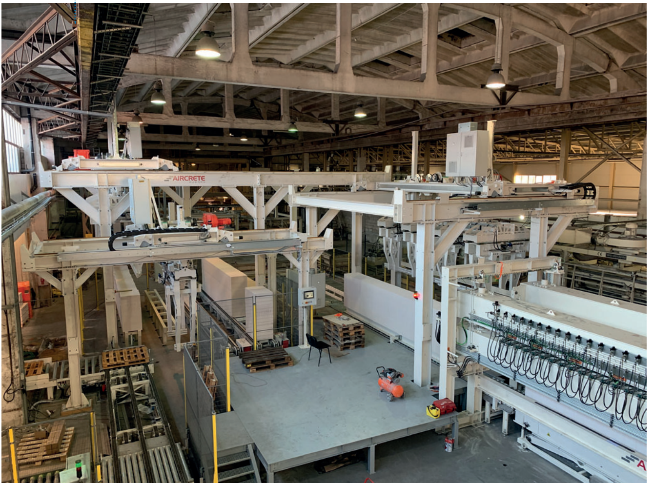
图3和图4: 2022年投入运营的砌块自动卸载流水线-3D模型和照片
