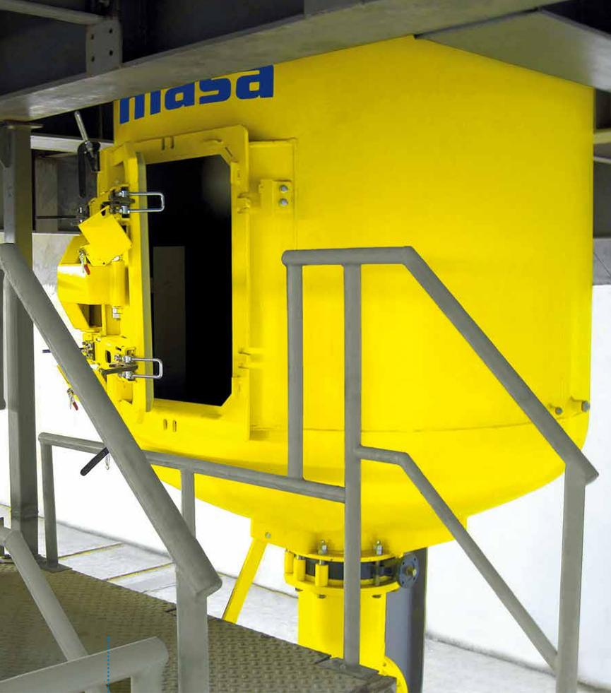
图4: 高性能搅拌机的侧向维护通道
