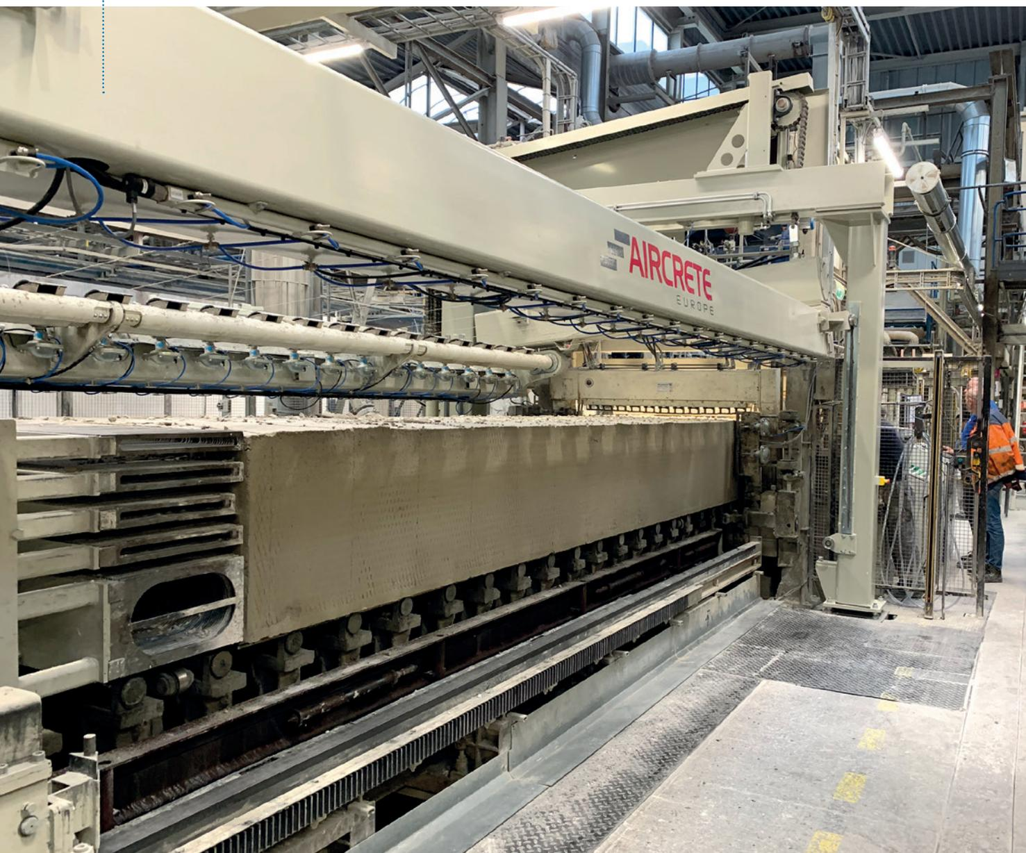
随着对蒸压加气混凝土(AAC)产品的需求不断增加，特别是对超光滑隔墙板的需求日益递增，AAC生产工艺可靠性从未像现在这样重要，这也是荷兰凯莱决定用新一代艾尔柯瑞特横切机升级切割线第一工段的主要考虑因素。除了提高可靠性外，新的横切机还确保了更高的产品质量和更低的能耗，从而在 2022 年为凯莱高质量生产打下基础。
