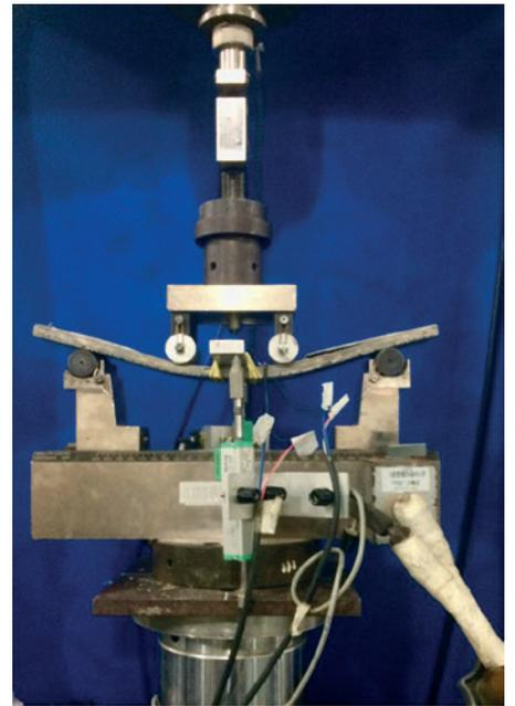
图2: 四点弯曲试验装置:
