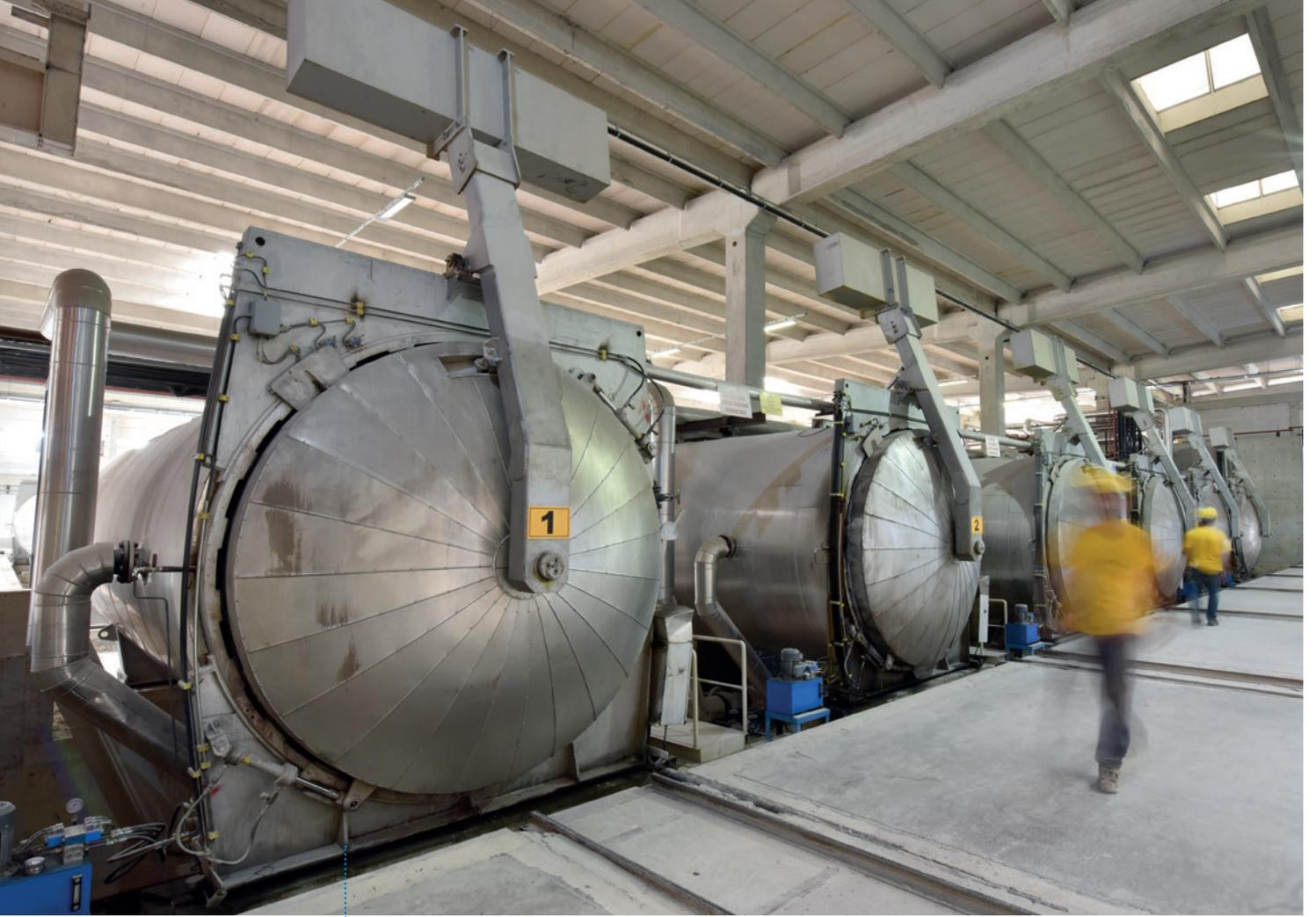
高压釜和刚经过高压灭菌的产品
