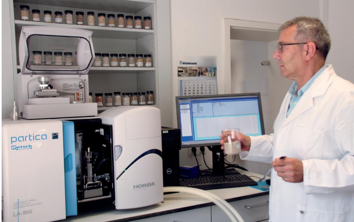
激光散射粒度分布分析仪甚至可以详细检测 $0.1\mu\text{m}$ 以下的颗粒，而使用喷气式筛分或振动筛分机的传统筛分方法仅限于 $32\mu\text{m}$
