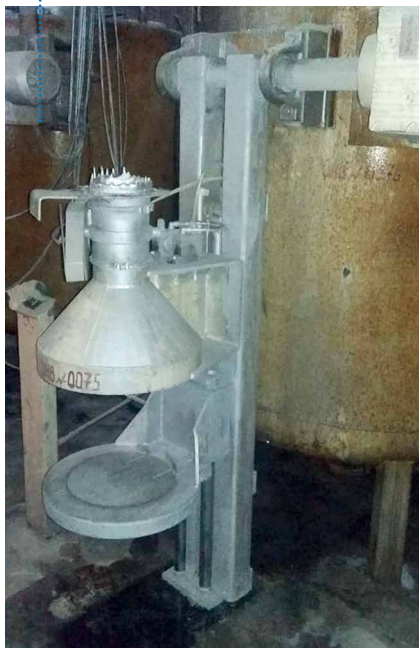
图4：用于将装有膨胀剂的容器自动倾斜和卸载到悬浮混合器中的装置
