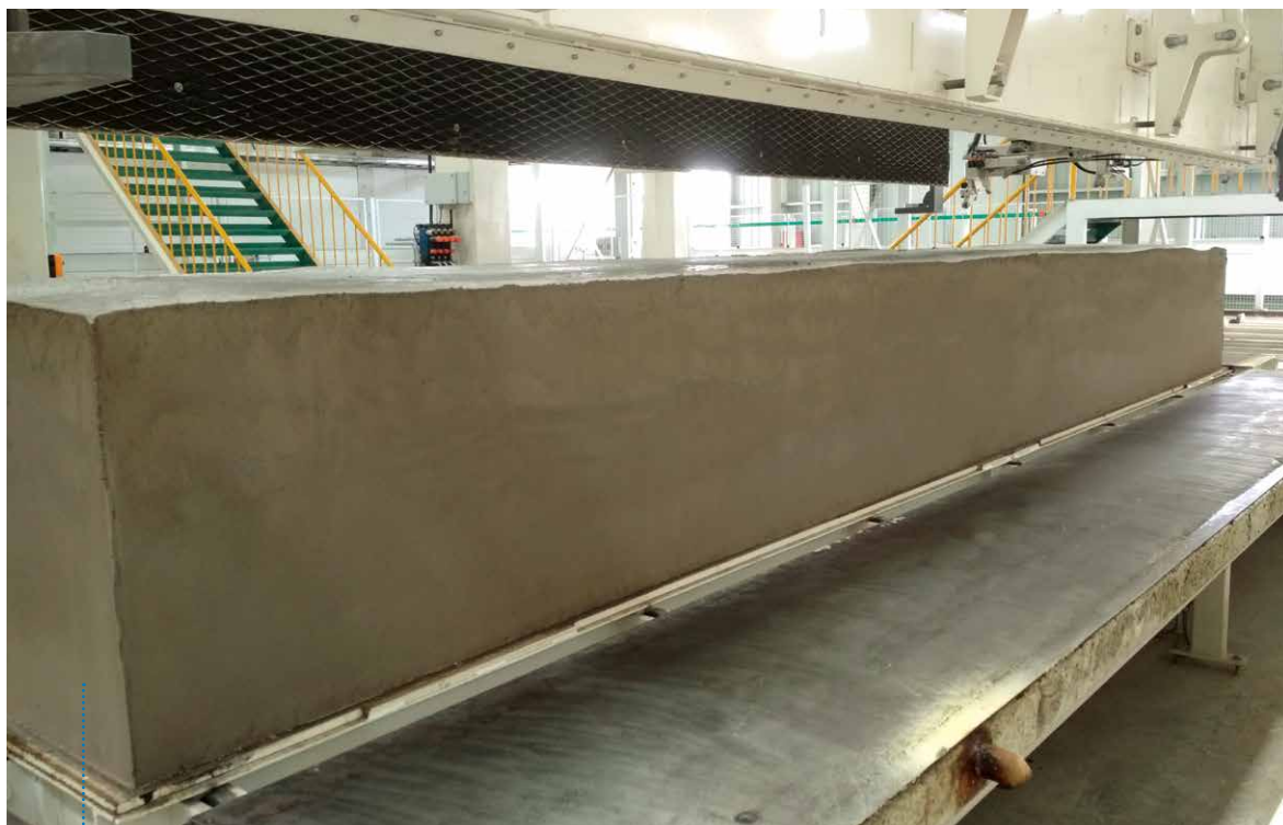
图7：所有艾尔柯瑞特工厂的标准操作，模具从四面打开
