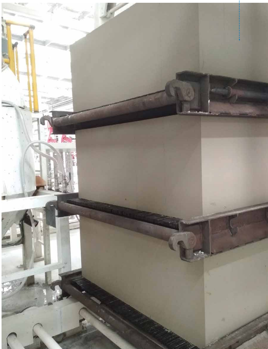
图13：蒸养框架上的坯体堆垛三层高
