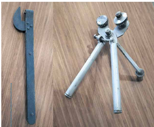
图3：无火花材料制成的工具
