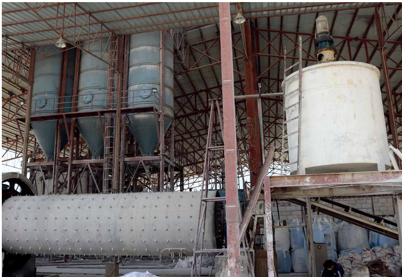
AAC Itta Udhyog的球磨段用于磨砂
