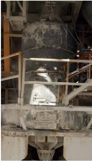
图2:生产生石灰的立式辊磨机 - 容量: 15吨/小时
