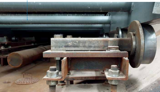
图14：带特殊轴承的高压釜滚轮特写
