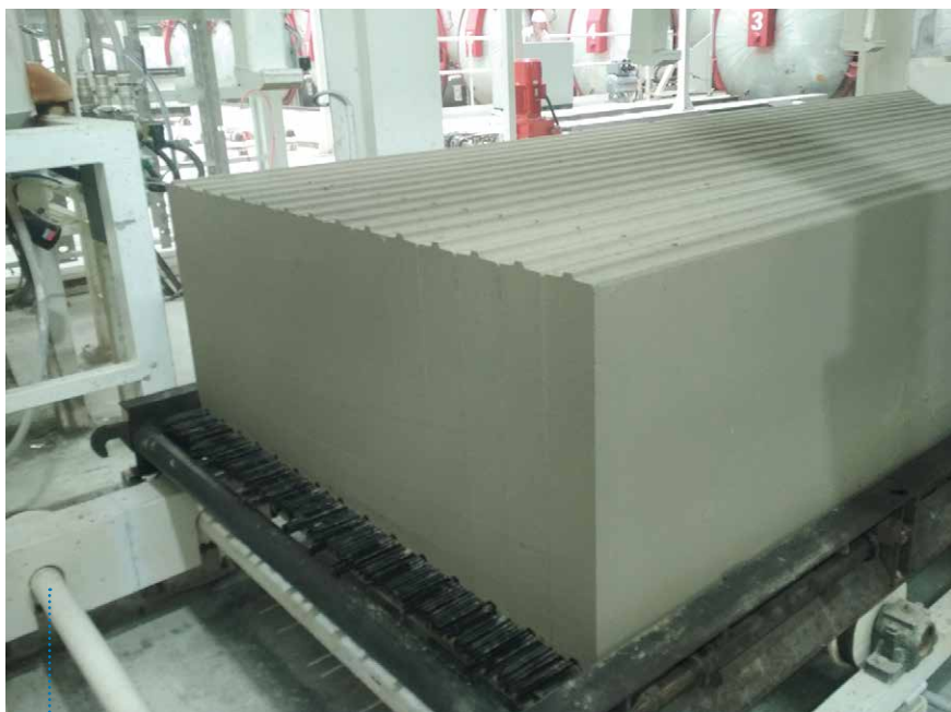
图12：顶部和底部切槽都在生坯阶段进行
