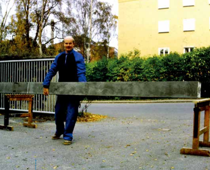
测试构件的长度为4.2 m，截面尺寸为130 x 210 mm，总重60公斤。破坏时的理论弯矩接近4 kNm -由于覆盖层和AAC之间的粘合力不足，测试结果约为2.5 kNm，必须通过系统测试湿度条件来改善该测试结果
