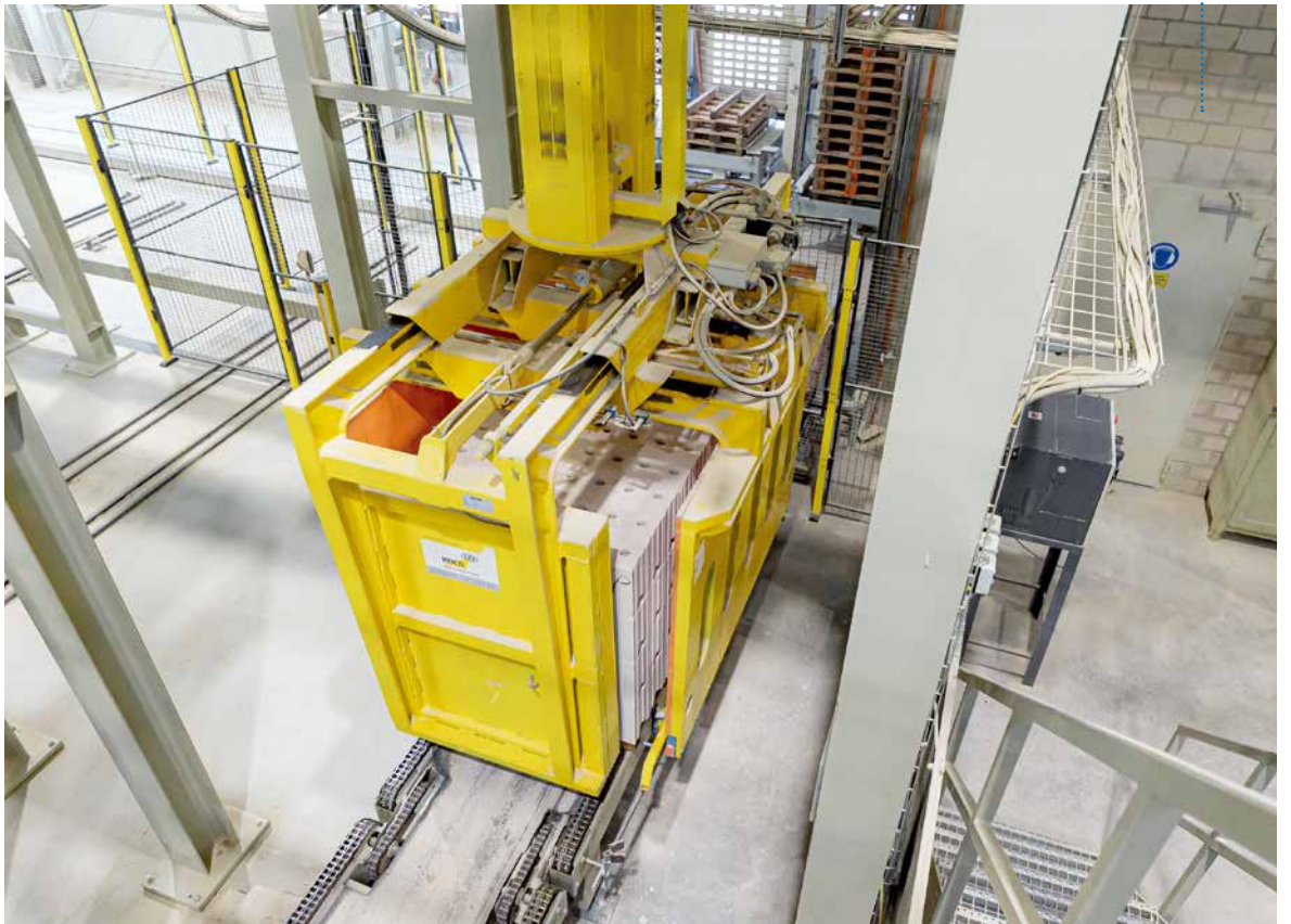
传送抓取装置将砖块堆积在一起
