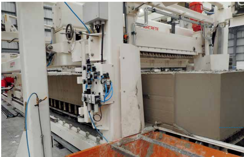
图 8：双线切割的高速切割架，用于切割超光滑表面
