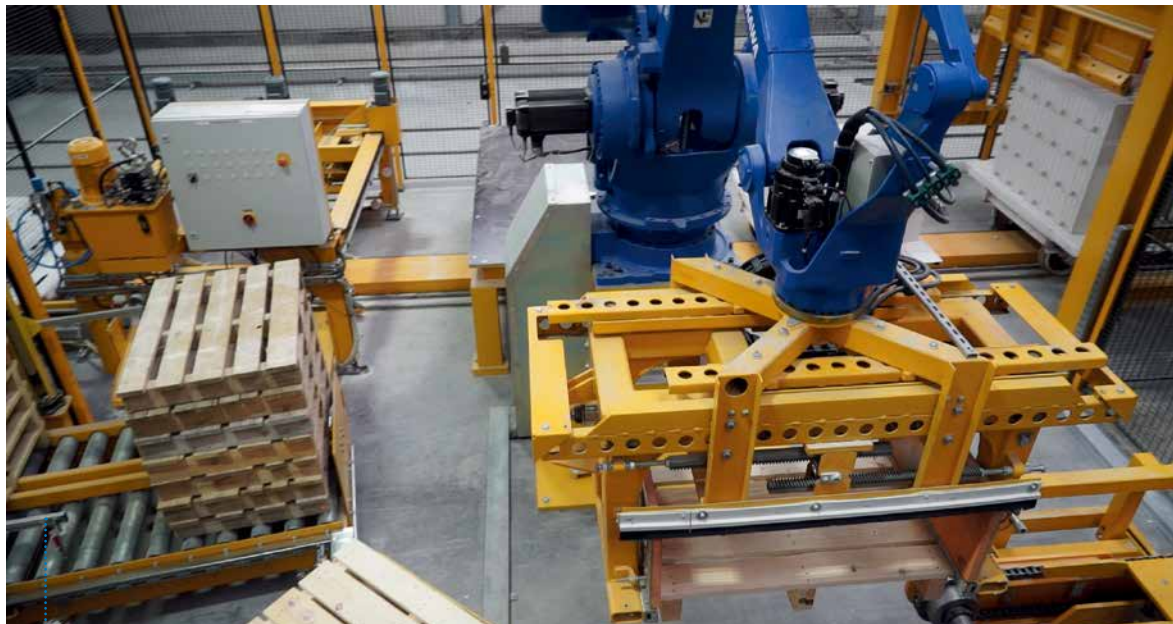
带有抓取装置的机器人能够处理托盘...
