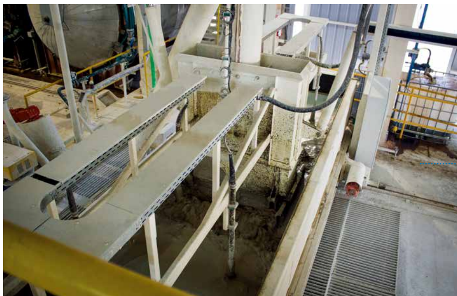
图 12: 均匀搅拌和模具 浇注是优质 AAC 湿坯的 关键
