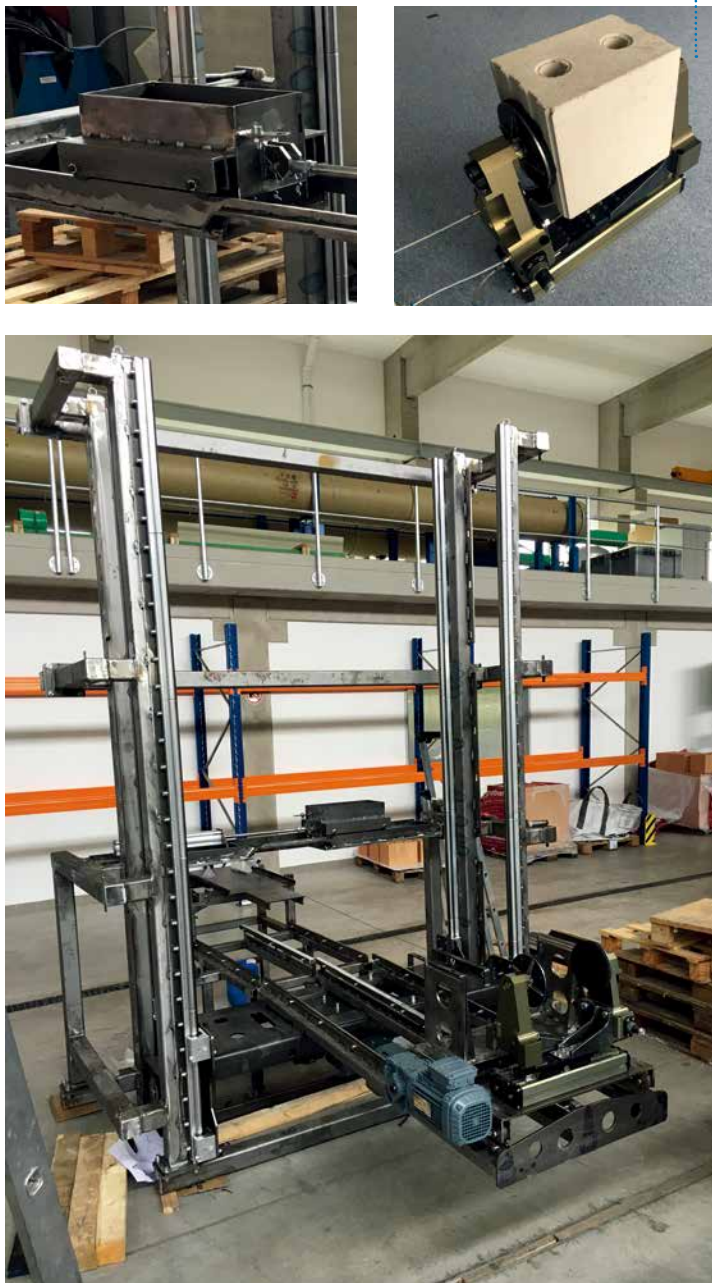
图7:IAB团队设计的砂浆施涂装置的预装配
