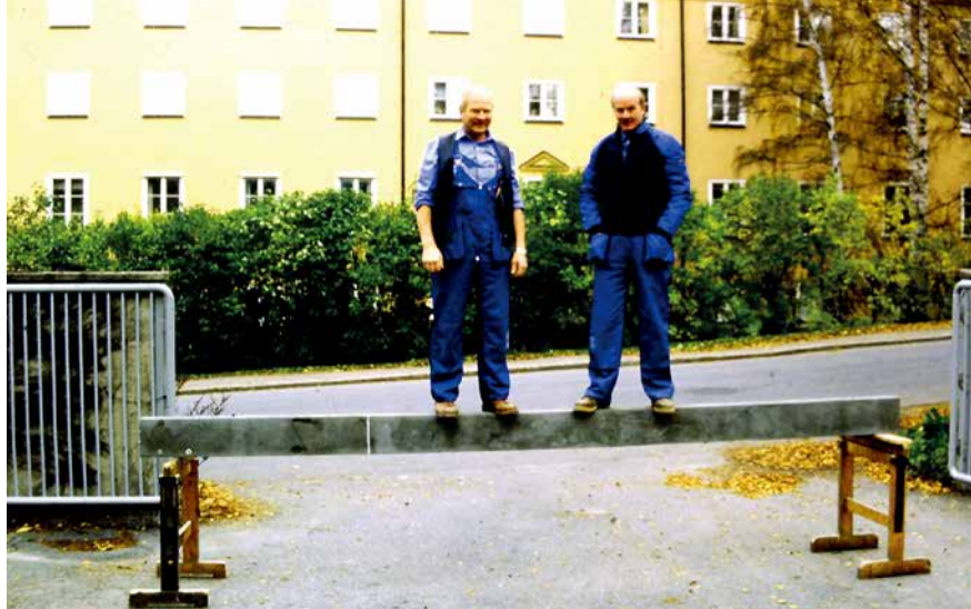
测试构件的长度为4.2 m，截面尺寸为130 x 210 mm，总重60公斤。破坏时的理论弯矩接近4 kNm -由于覆盖层和AAC之间的粘合力不足，测试结果约为2.5 kNm，必须通过系统测试湿度条件来改善该测试结果
